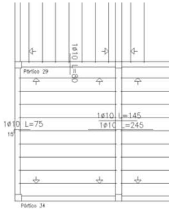
Fig. N° 3.76 Armadura de negativos en losa
