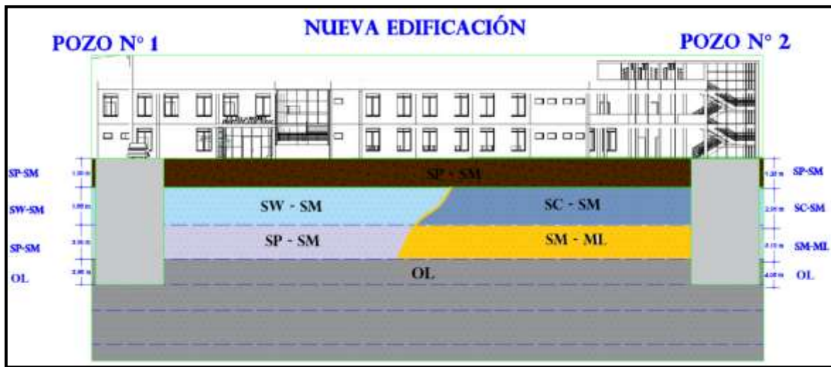
Figura 3.4. Estratificación del suelo (fuente: elaboración propia)
