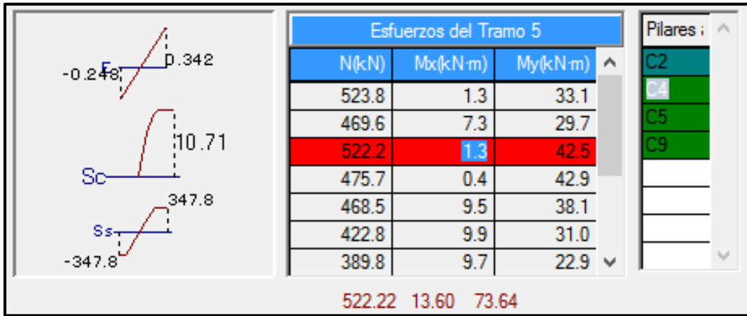
Figura 3.14. Esfuerzos de diseño de la columna C4 (Fuente: CYPECAD 2014)
