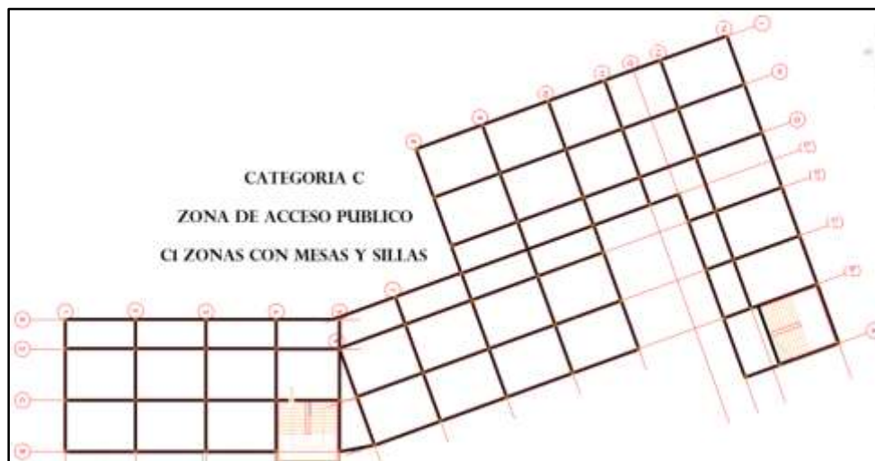
Figura 3.6. Categoría de la primera losa (fuente: CYPECAD 2014)
