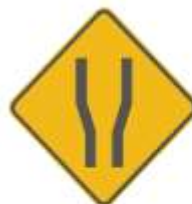
SP-41 ENSANCHE SIMÉTRICO DE LA CALZADA
