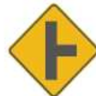
SP-20 VÍA LATERAL DERECHA
