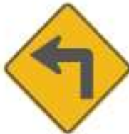
SP-1 CURVA PELIGROSA IZQUIERDA
