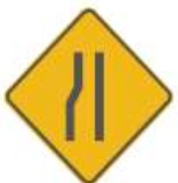
SP-40 REDUCCIÓN ASIMÉTRICA DE LA CALZADA IZQUIERDA
