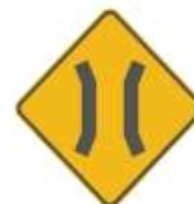
SP-44 PUENTE ANGOSTO
