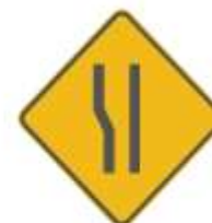
SP-42 ENSANCHE ASIMÉTRICO DE LA CALZADA IZQUIERDA
