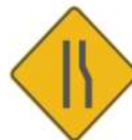
SP-39 REDUCCIÓN ASIMÉTRICA DE LA CALZADA DERECHA
