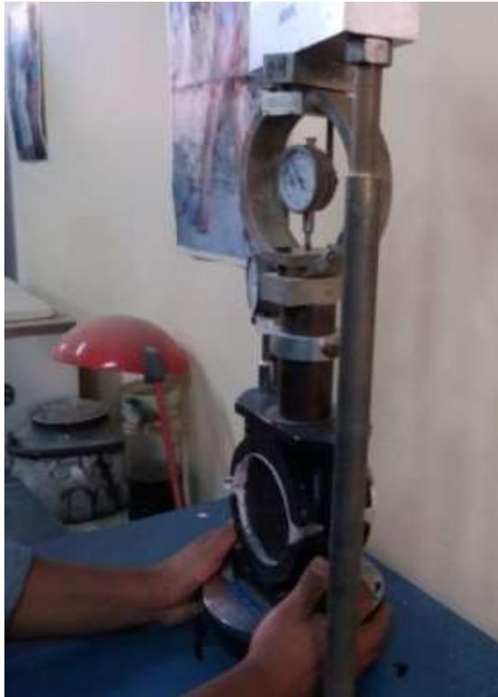
Figura N°19. Briquetas después de pasar por la prensa
