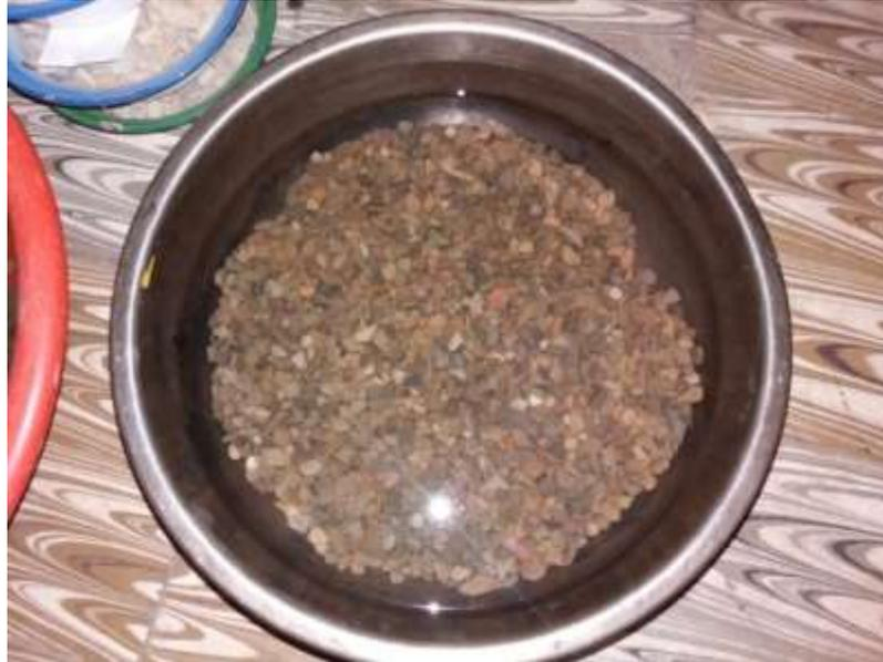
La muestra se lava inicialmente con agua hasta eliminar completamente el polvo u otras sustancias extrañas adheridas a la superficie de las partículas; se seca a continuación en un horno a 100° - 110°C
