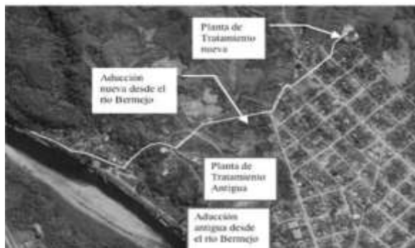
Figura 3. 8 Aducciones desde las obras de toma del río Bermejo
