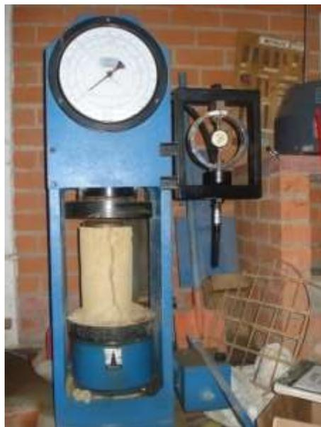
Fotografía 2.4: Ensayo de compresión simple
