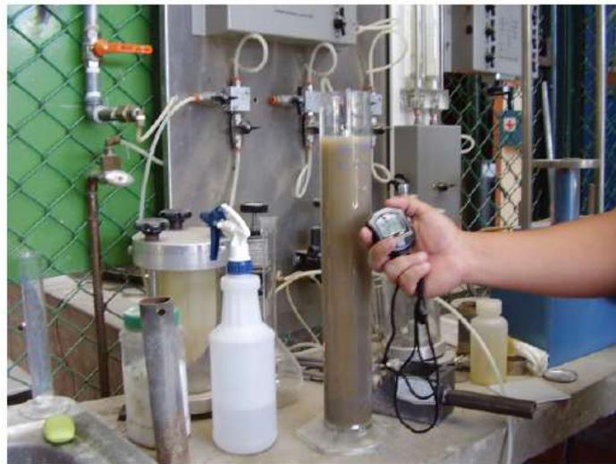
Fotografía 2.3: Prueba del hidrómetro
