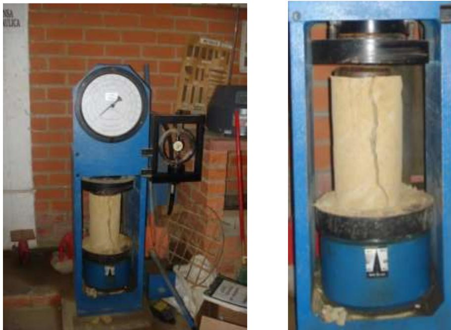
Fotografía 3.9: Ensayo de compresión simple (resistencia del suelo)
