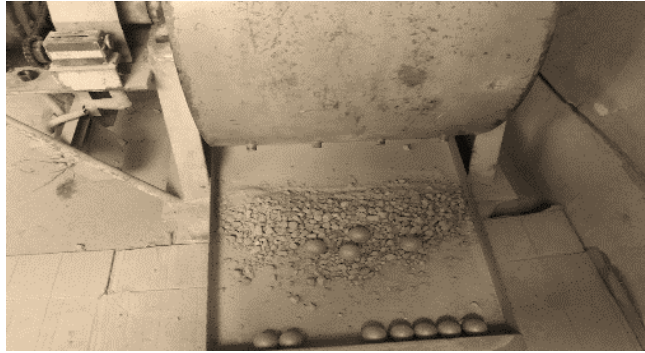
Fotografía 3.3: Material granular listo para tamizar en el tamiz No. 12
