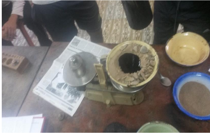
Fotografía 4.8: Realizando el pesado de los agregados con el porcentaje óptimo de DISEÑO 1 = 5.40%, DISEÑO 2 = 5.60%, DISEÑO 3 = 5.80% de asfalto
