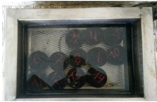
Fotografía 4.6: Briquetas en baño maría a temperatura de 60°C
