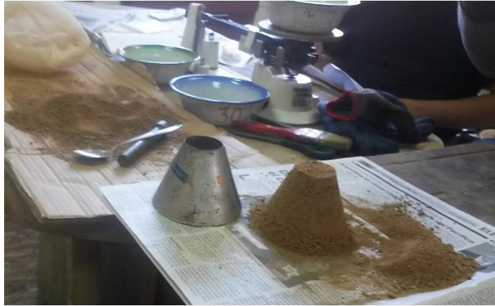
Fotografía 3.7: Verificando la humedad del material
