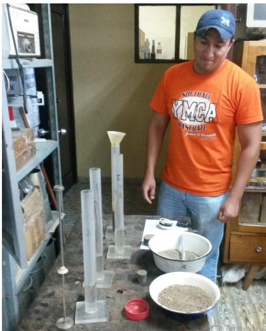
Fotografía 3.4: Observación del ensayo de equivalente de arena y agregado fino
