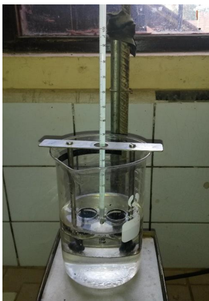
Fotografía 3.14: Punto de ablandamiento anillo y bola
