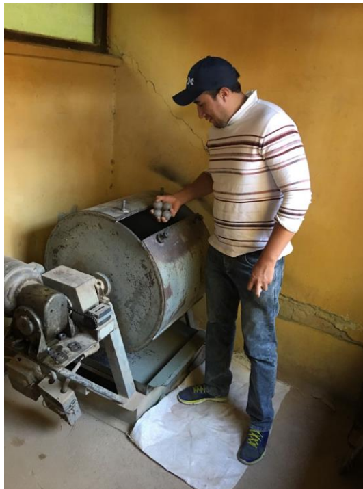
Fotografía 3.2: Echando las esferas de acero
