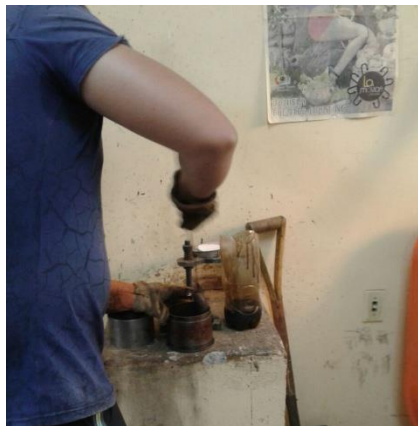
Fotografía 4.3: Colocado de la mezcla al molde cilíndrico de compactación
