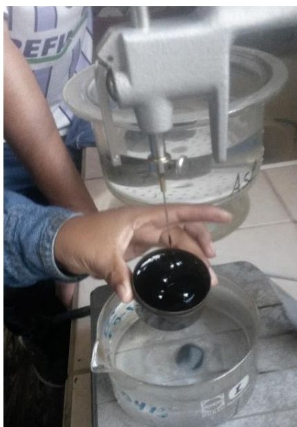
Fotografía 3.13: Penetración de la muestra
