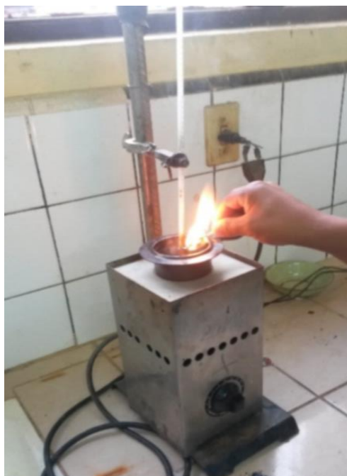
Fotografía 3.10: Calentado la muestra para el punto de inflamación
