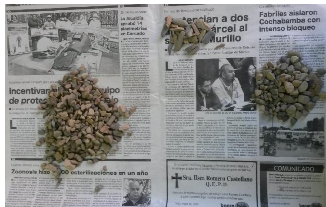
Fotografía 3.1: Apartado de las partículas fracturas, canto rodado, laminadas y alargadas.
