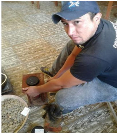
Fotografía 4.11: Sacado de briqueta con gato hidráulico
