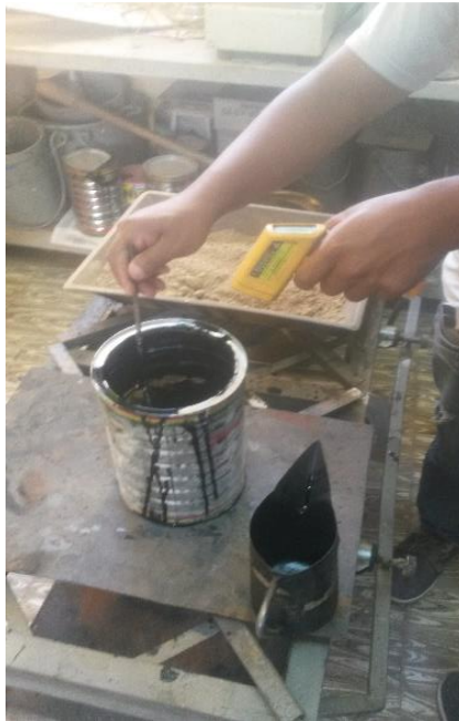
Fotografía 4.9: Midiendo la temperatura del asfalto con termómetro laser
