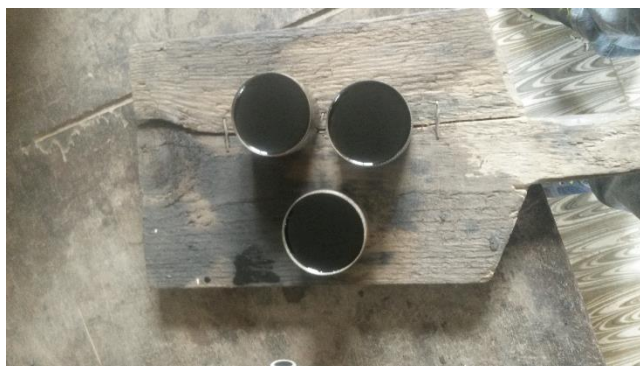
Fotografía 3.11: Muestras de mezcla asfáltica
