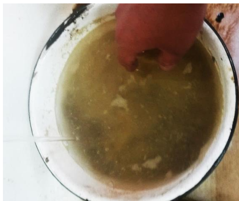
Fotografía 3.9: Agregado saturado con sulfato de sodio
