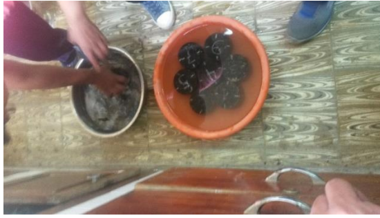
Fotografía 4.5: Briquetas en baño maría a temperatura de 25°C
