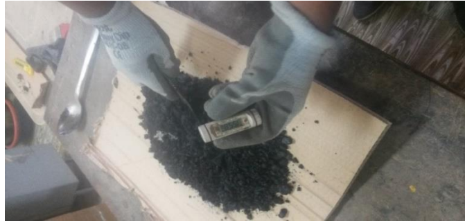
Fotografía 4.10: Lectura de temperatura de mezcla para su compactación en 110, 120, 130 y 140°C
