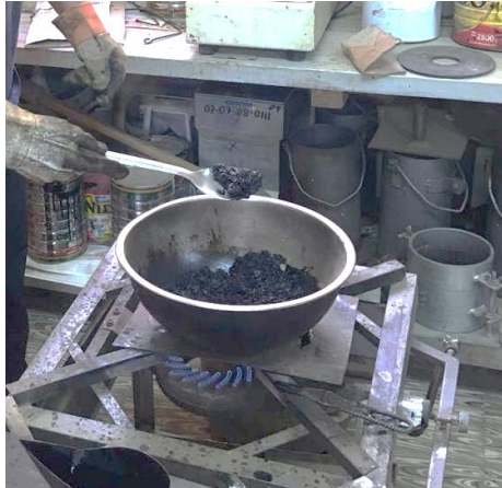
Fotografía 4.2: Mezclado de la muestra de manera manual
