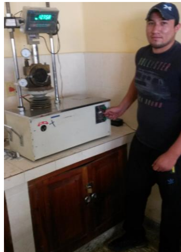
Fotografía 4.7: Rompiendo la briqueta en el Equipo Marshall
