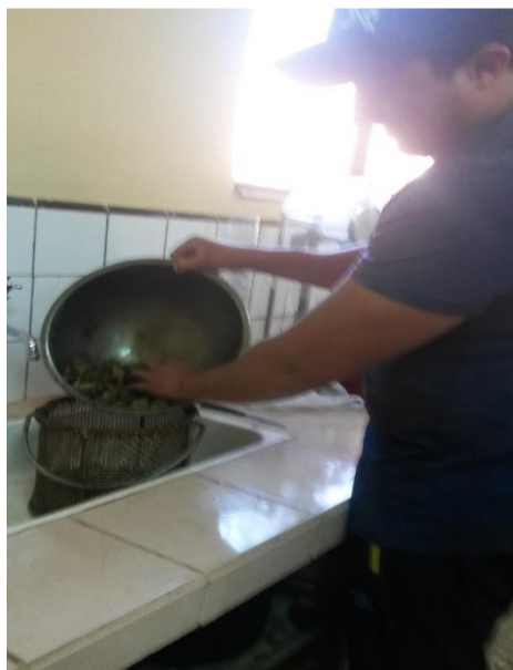
Fotografía 3.6: Vertido del agregado grueso en la canastilla metálica
