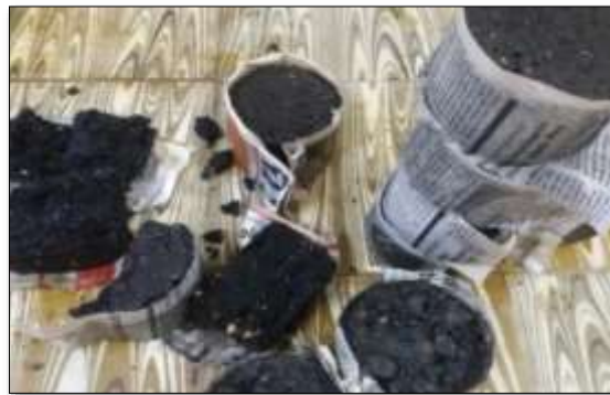
Figura 16 Briquetas después de pasar por la prensa.
