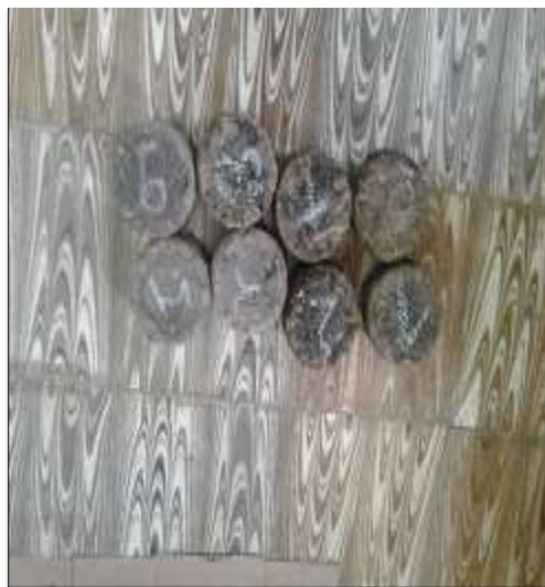
Figura 57 Briqueta después del ensayo de cántabro
