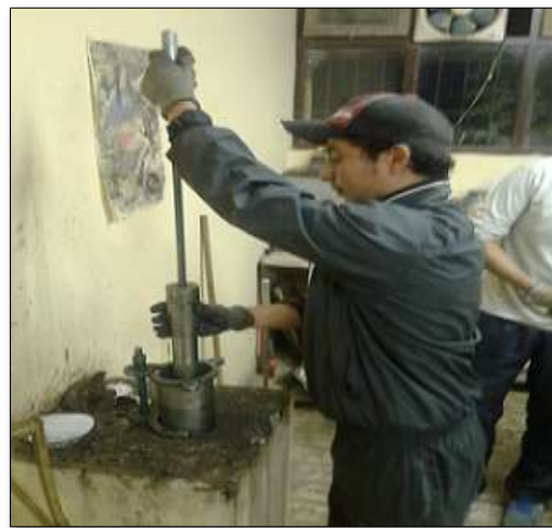
Figura 13 Compactando la briqueta Marshall
