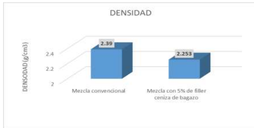
Figura 61 Comparación de la densidad de las mezclas
