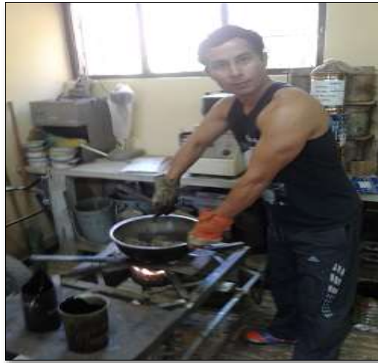
Figura 12 Preparando la mezcla asfáltica.
