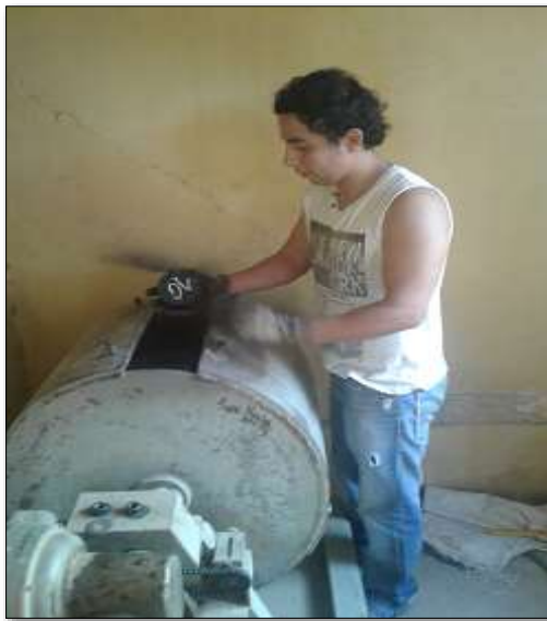
Figura 56 Sometiendo la briqueta al ensayo de cántabro
