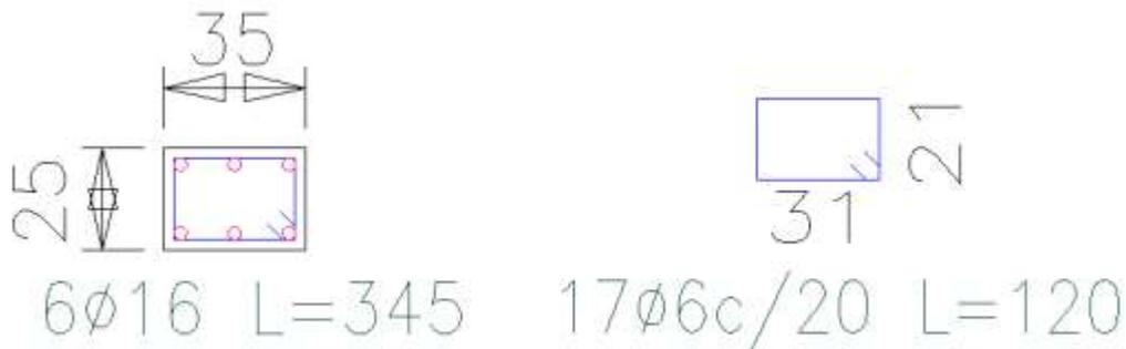
Ilustración 30: Despiece de armadura en Columna; Elaboración Propia
