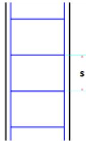
$$s \leq \begin{cases} b \text{ o } h \text{ (el de menor dimensión)} \\ 15 * \phi_{\text{de la armadura longitudinal}} \end{cases}$$
