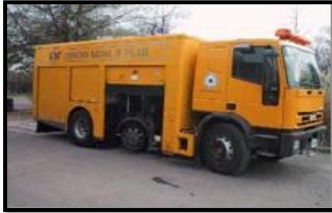
Compuesto por un camión cisterna de 5000 litros de capacidad para regar agua en la calzada, proporcionando una lámina de 1 mm. De espesor a su paso.
