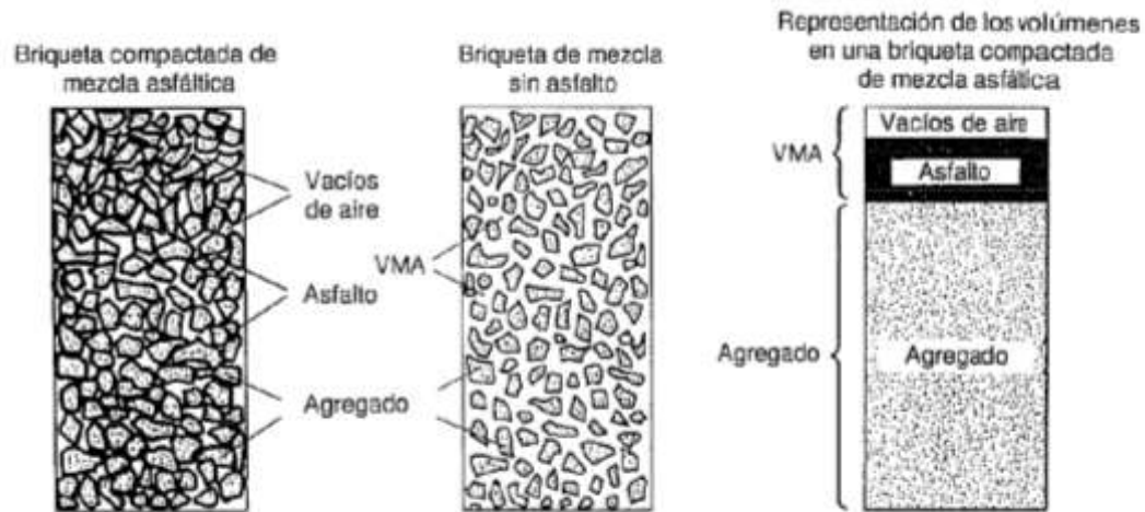
Figura N° 1. Ilustración del VAM en una probeta de mezcla compactada.
