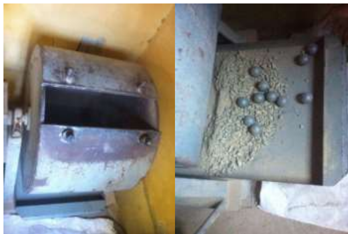
Figura N° 10. Máquina de desgaste por abrasión y material post ensayo.
