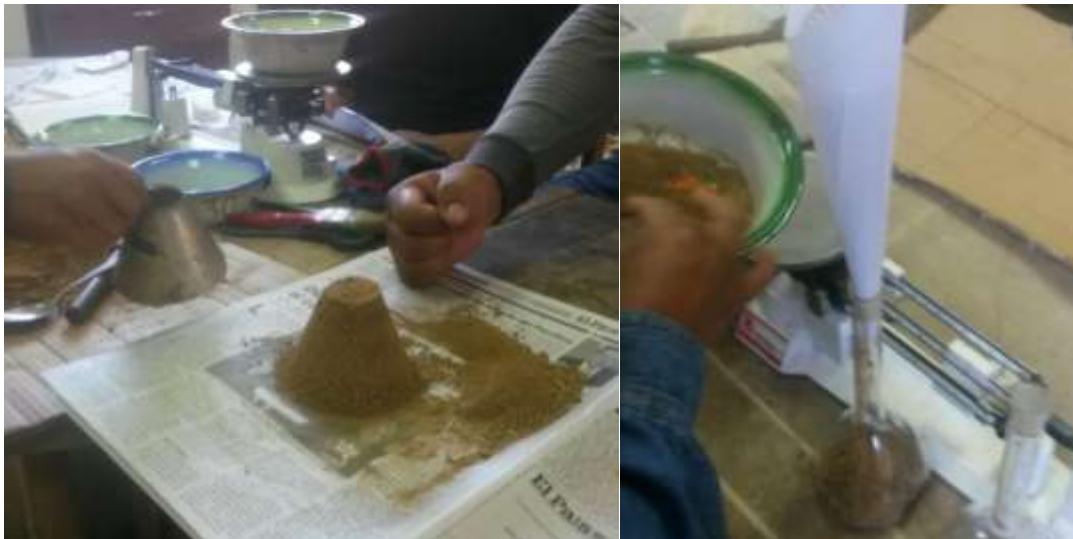
Figura N° 13. Verificando la humedad de la muestra para empezar el ensayo.
