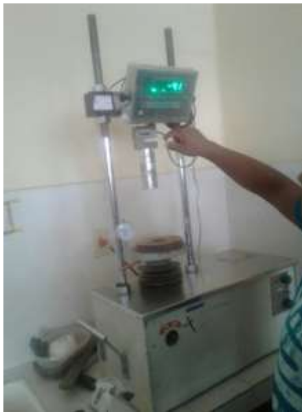
Figura N° 28. Prensa Marshall para el ensayo de Estabilidad y Fluencia.
