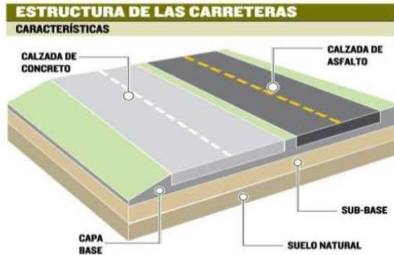
Esquema de paquete estructural para pavimento flexible y rígido
