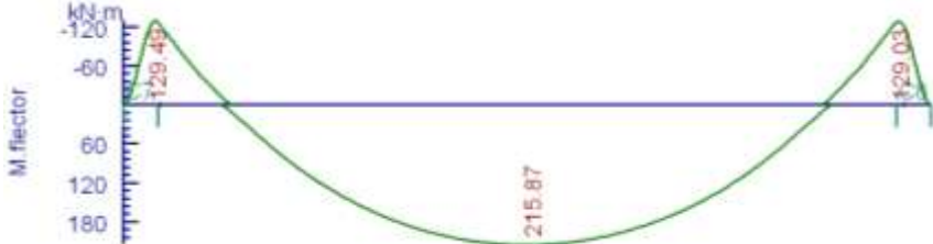
Figura 4.13. Falla de la viga C7-C8, diseño convencional (Fuente CYPECAD 2014)
