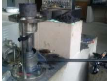
Figura 79. Extraer probetas de sus moldes con un extractor de núcleos
