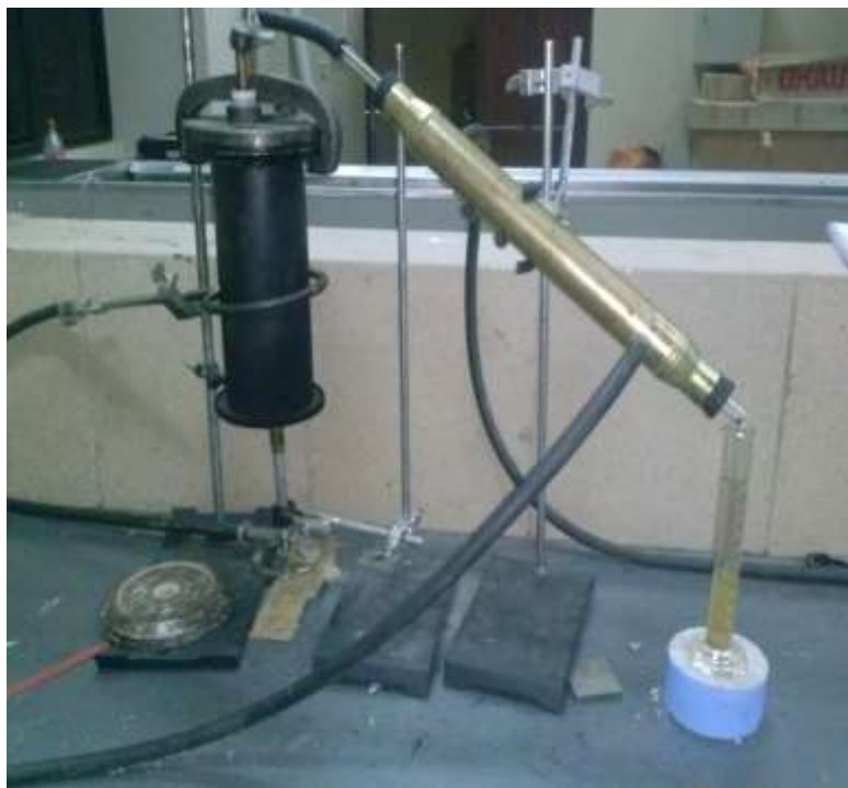
Figura 50. Fin del proceso de destilación y registro del volumen destilado
