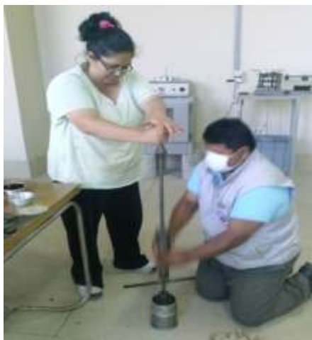
Figura 78. Fabricar probetas con 75 golpes por cara
