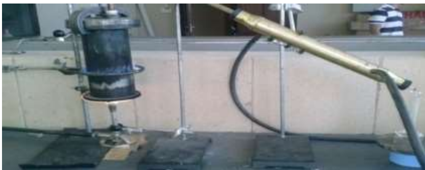
Figura 48. Aplicando calor mediante el anillo quemador
