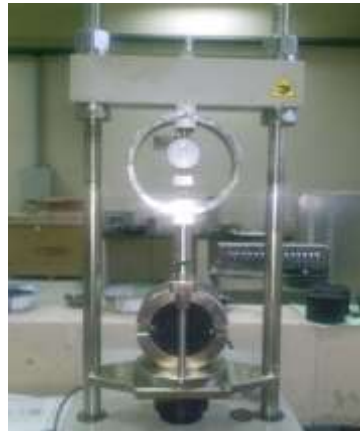
Figura 88. Colocado de la briqueta en la mordaza Marshall
