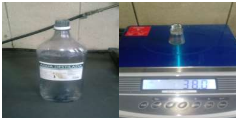
Figura 52. Peso del picnómetro calibrado con agua
