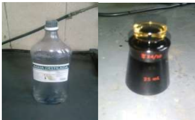
Figura 54. Picnómetro con muestra rellenado con agua
