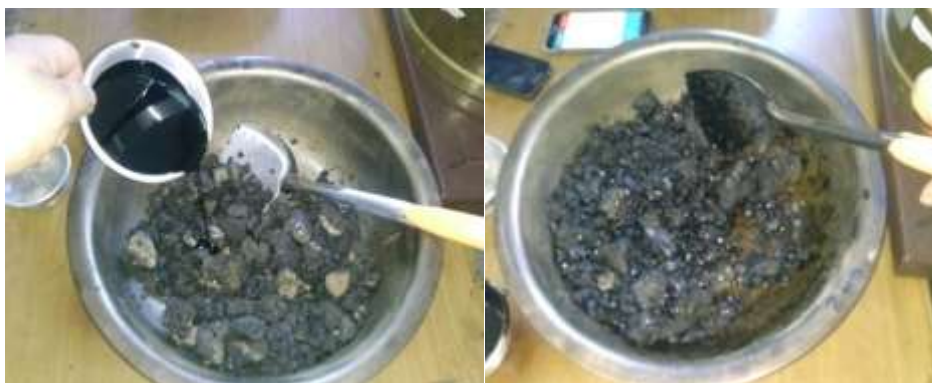
Figura 75. Agregar emulsión a 60°C y mezclar hasta completar dispersión de emulsión
