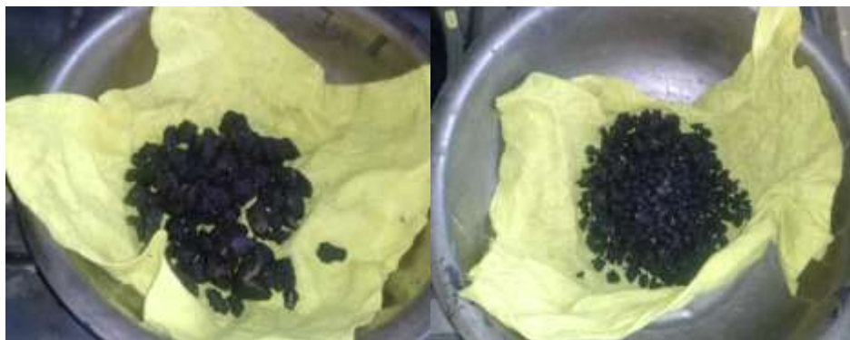
Figura 60. Secado superficial de las muestras saturadas
