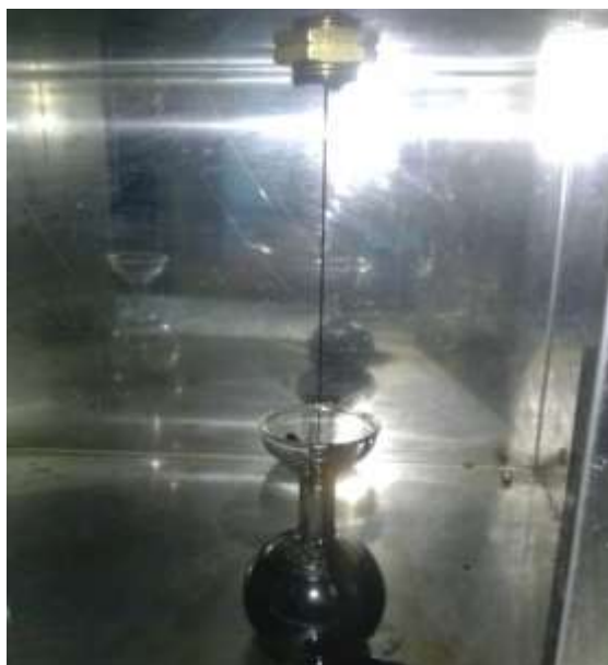
Figura 45. Una vez igualada la temperatura quitar el corcho y dejar fluir la emulsión
