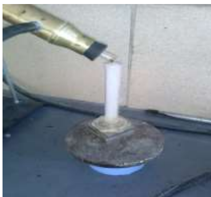
Figura 49. Proceso de destilación del agua en la emulsión asfáltica
