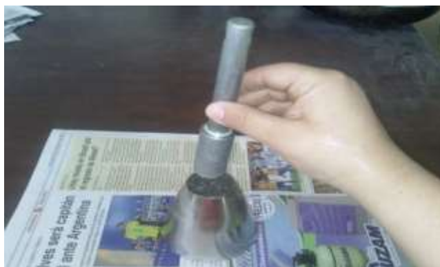
Figura 66. Compactado con 25 golpes distribuidos uniformemente sobre la superficie
