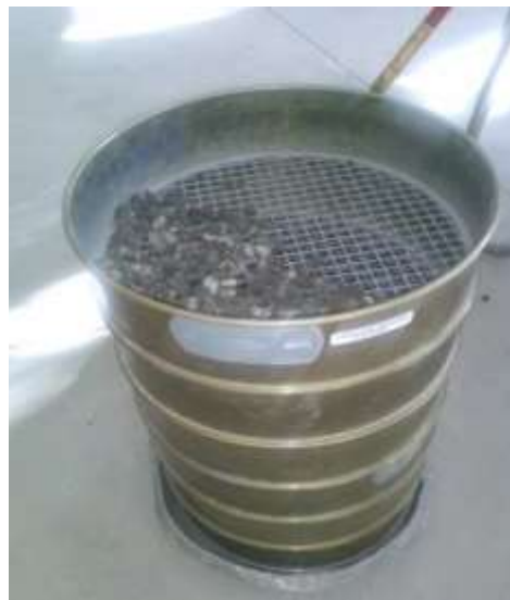
Figura 57. Tamizado de la muestra para separar Agregado grueso y fino
