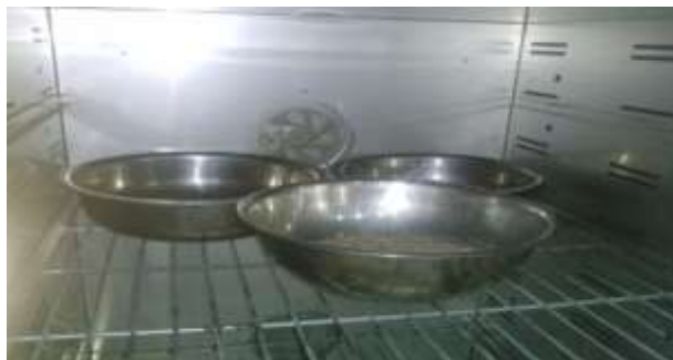
Figura 40. Secado del agregado lavado en el horno
