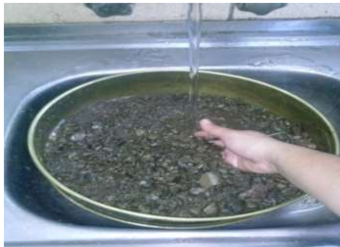
Figura 39. Método del lavado
