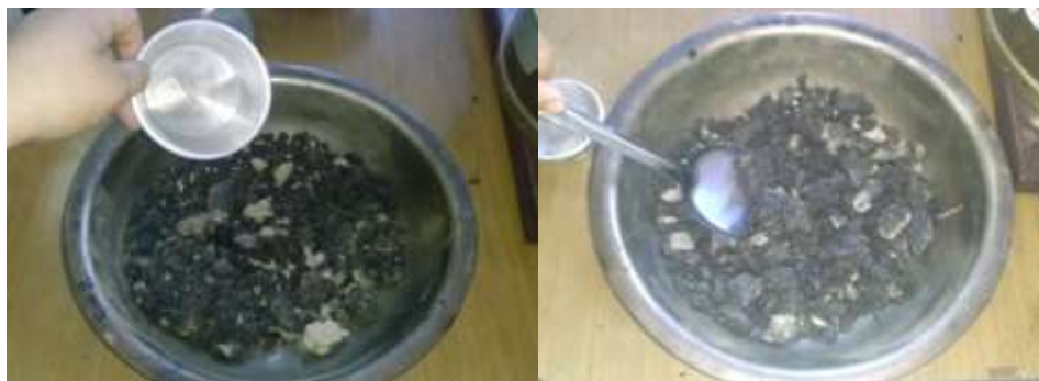
Figura 74. Agregado de agua al 3% como contenido total y mezclar 1min
