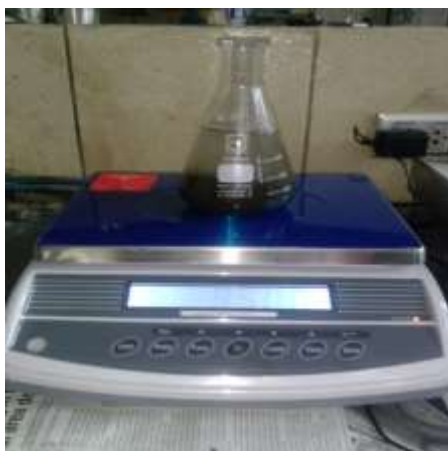
Figura 70. Pesamos la muestra + matraz + agua
