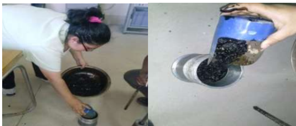
Figura 77. Introducir la mezcla en los moldes en tres capas con 25 varillas
