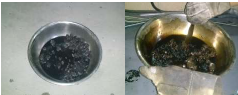
Figura 32. Dejar reposar la muestra con el solvente para ayudar a la disgregación
