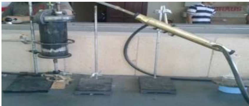
Figura 47. Armar el equipo e introducir 200 grs. de emulsión asfáltica
