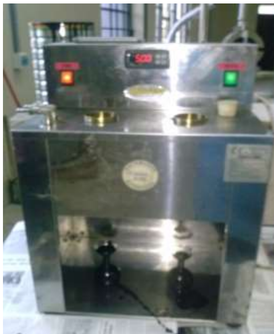
Figura 46. Registrar el tiempo en que la emulsión llega al menisco del frasco
