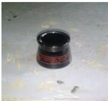
Figura 53. Registrar el peso del picnómetro con muestra
