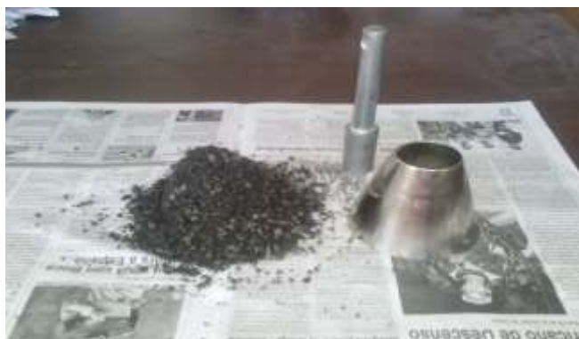
Figura 67. Verificación de la condición de la muestra saturada con superficie seca
