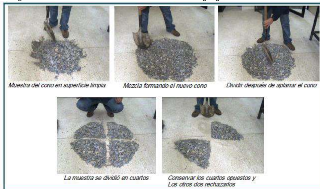
Imagen N°4.- Método de Cuarteo del Material Grueso (ganga)
