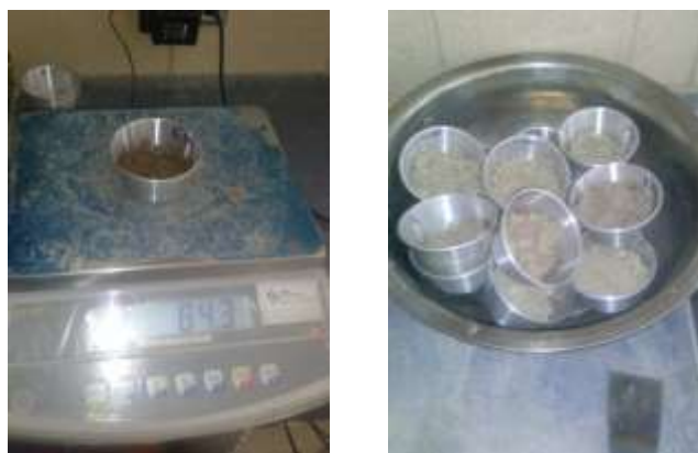
Figura 38. Extracción y peso de la muestra de cada C.B.R. después de la penetración.
