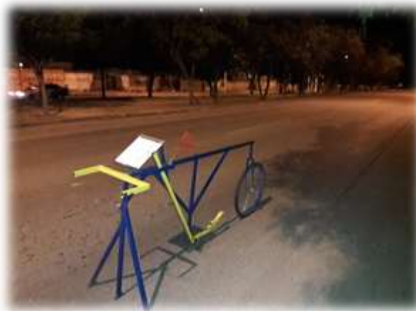
FIGURA 48. Posicionamiento del dispositivo de Merlín, para ejecutar el ensayo.
