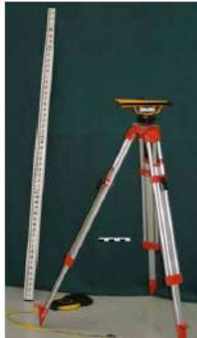
FIGURA 2. Nivel de ingeniero y mira topográfica.
