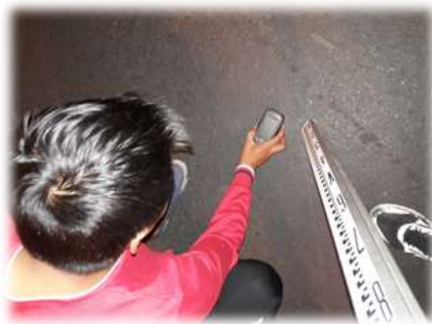
FIGURA 43. Lecturado de la cota y lecturado de la altura del punto.
