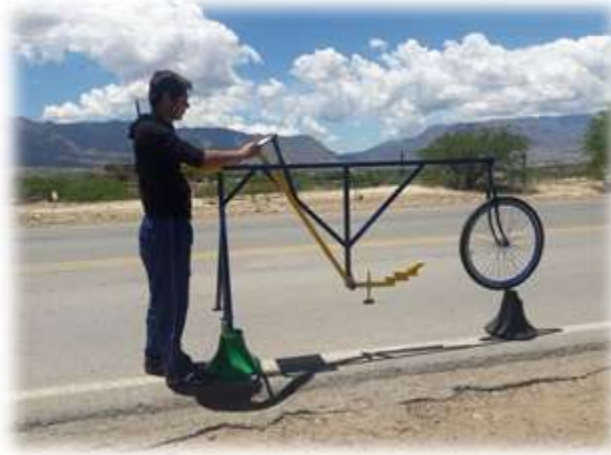
FIGURA 46. Calibración del dispositivo de Merlín.
