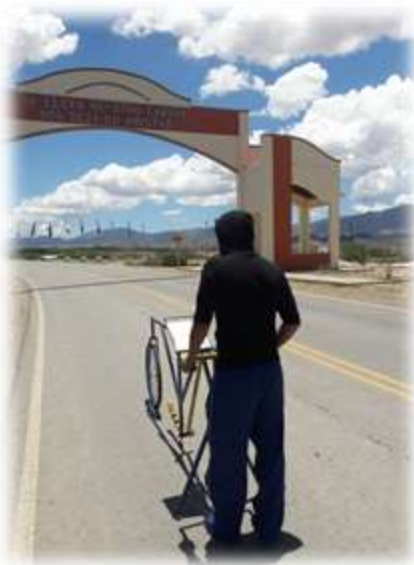
FIGURA 49. Recolección de datos con el Dispositivo de Merlín.
