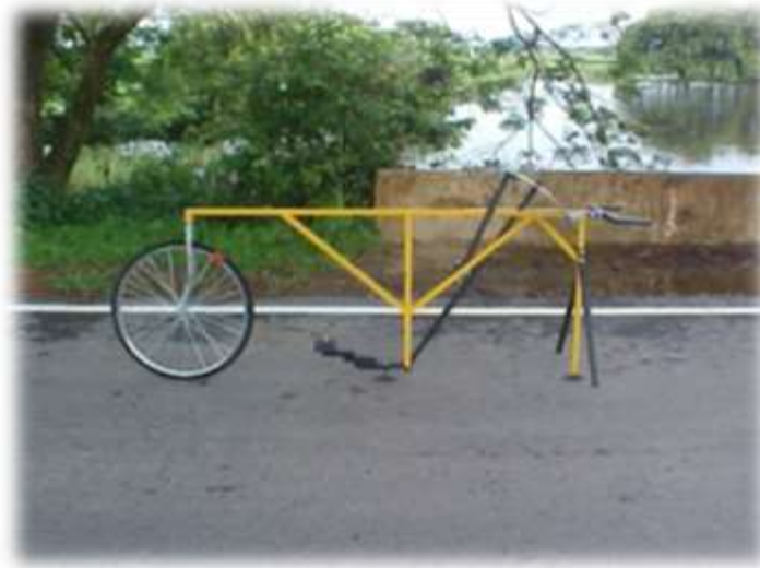
FIGURA 11. Rugosímetro merlín modelo MK1.
