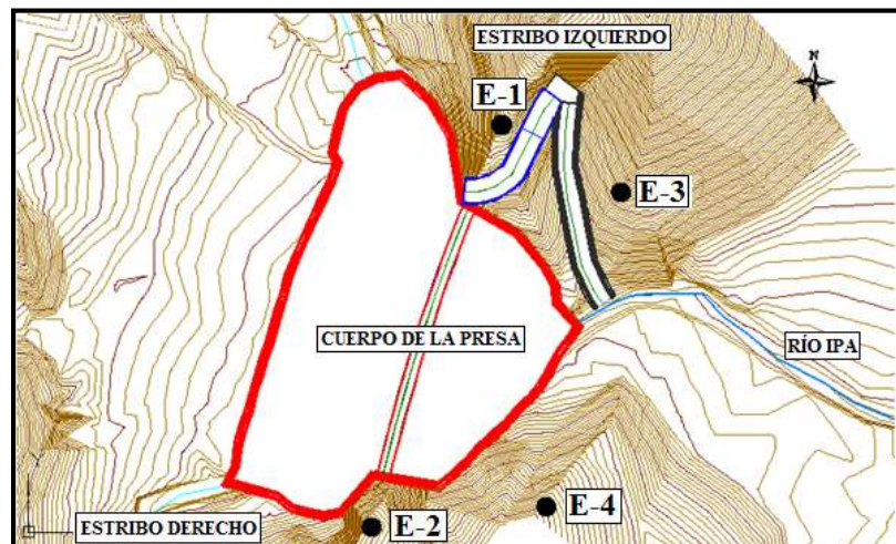
Figura 3.12. Ubicación de estaciones base para control topográfico
