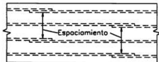
Figura N° 13. Espaciamiento entre varillas en empalme escalonado
