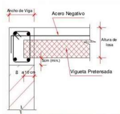
Figura N° 24. Conexión viga-vigueta
