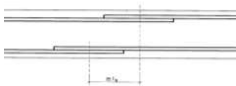
Figura 2.5 Empalme por Traslapo
