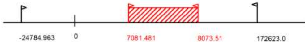
Figura 3.25 Conjunto solución de la fuerza de pretensado
