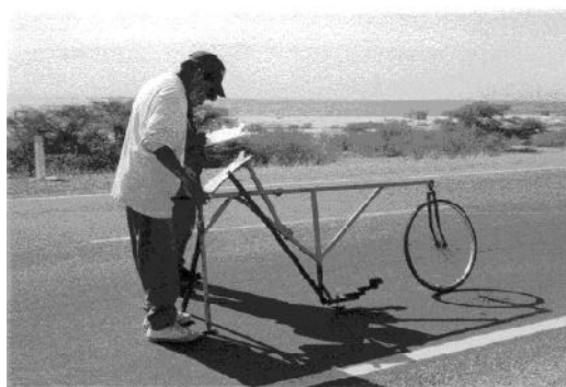
Figura 2.31 Rugosímetro Merlín en funcionamiento
