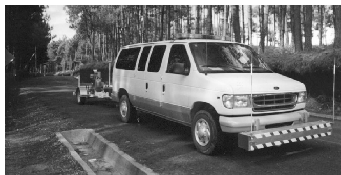
Figura 2.30 Equipo RSP en funcionamiento
