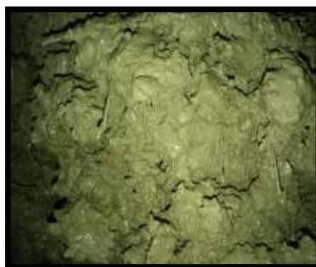
*Fotografía 3.11 Realización del hormigon reforzado con fibras de polipropileno*
