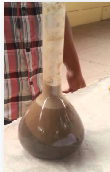
Figura 3.14 Realización del ensayo de peso específico
