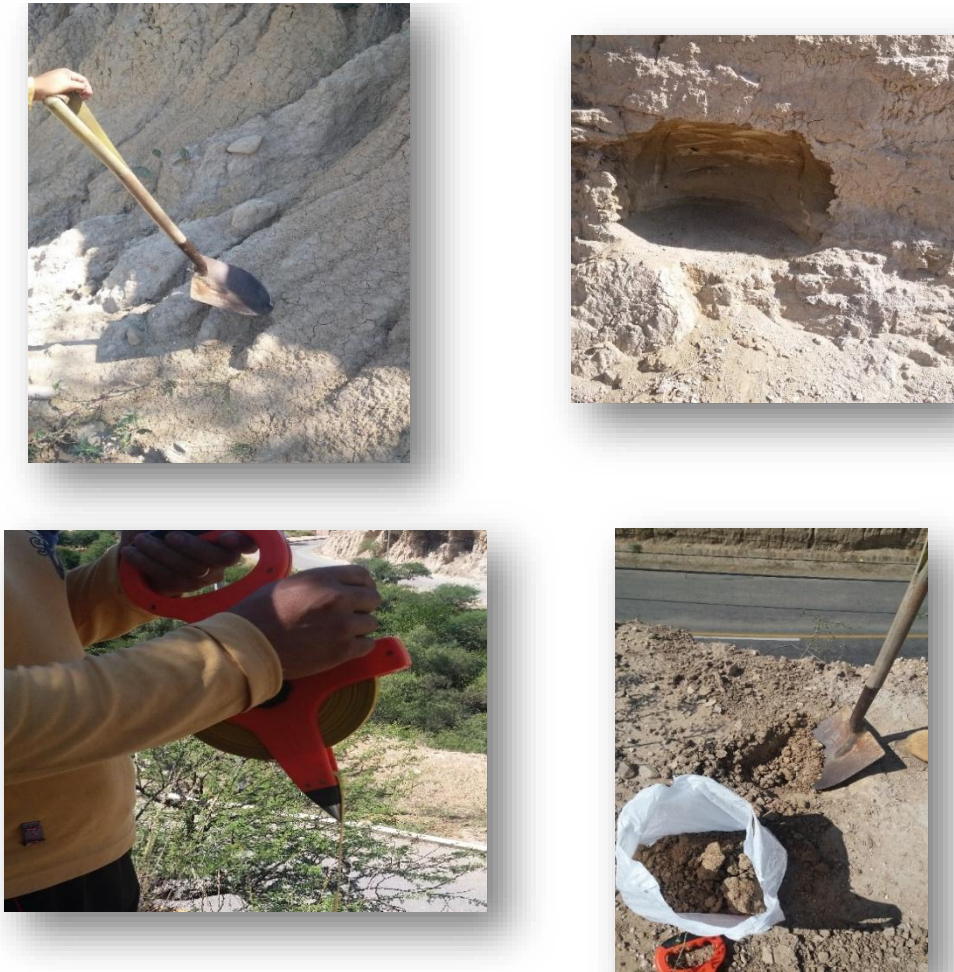
Figura 3.9 Realización de la extracción del material
