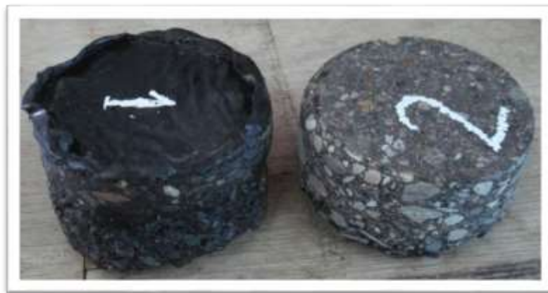
Fig. 4.1.1. Testigos extraídos: 1 sector Exudación; 2 sector “sano”
