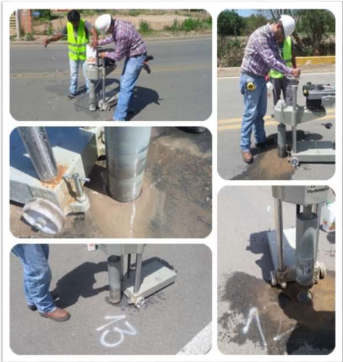
Fig. 3.4.2.1. Extracción De Los Núcleos Del Tipo Exudación
