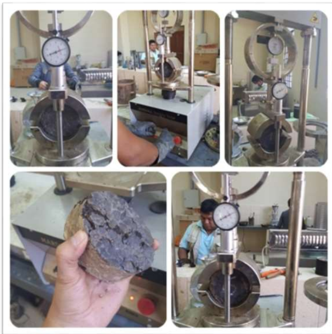
Fig. 3.4.6. Medición De La Resistencia A La Deformación Plástica
