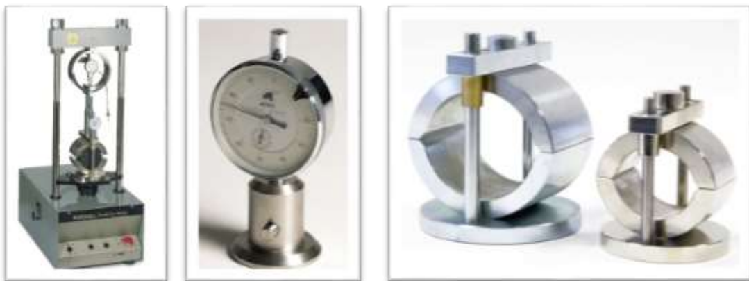
Fig. 3.3.5 – Imagen Equipo Marshall Más Medidor De Flujo Y Anillos
