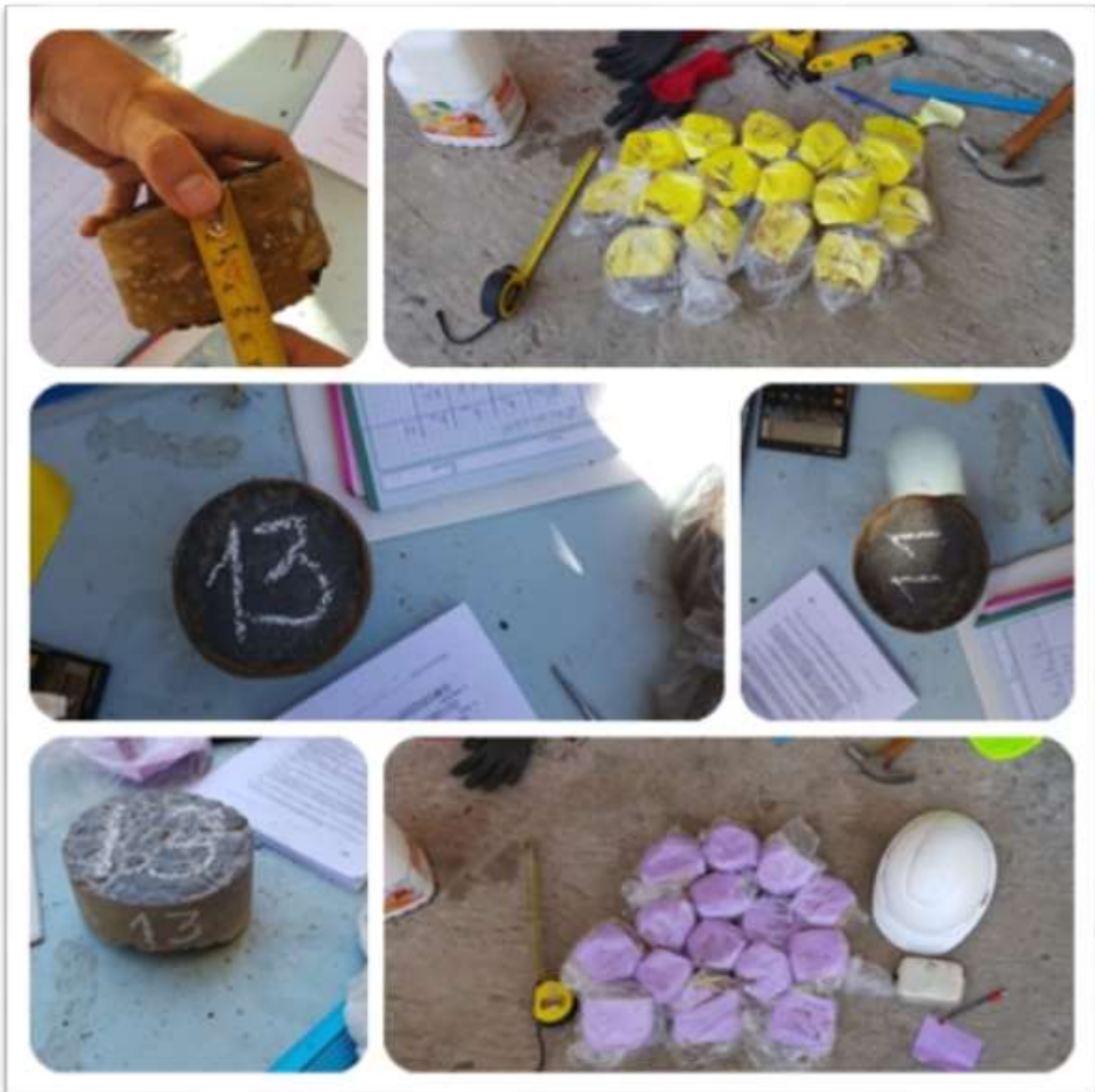
Fig. 3.4.2.4. Medición De Los Espesores De Cada Núcleo De Los Dos Tipos De Fallas
