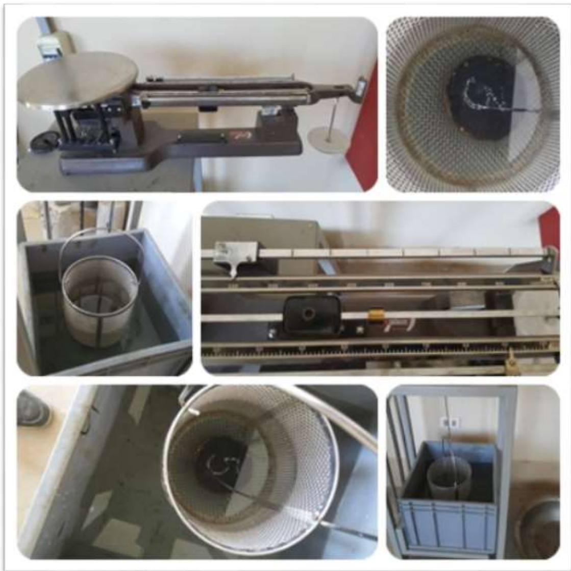
Fig. 3.4.4.2.1. Medición De Los Pesos De Cada Núcleo Sumergido De Los Dos Tipos De Fallas
