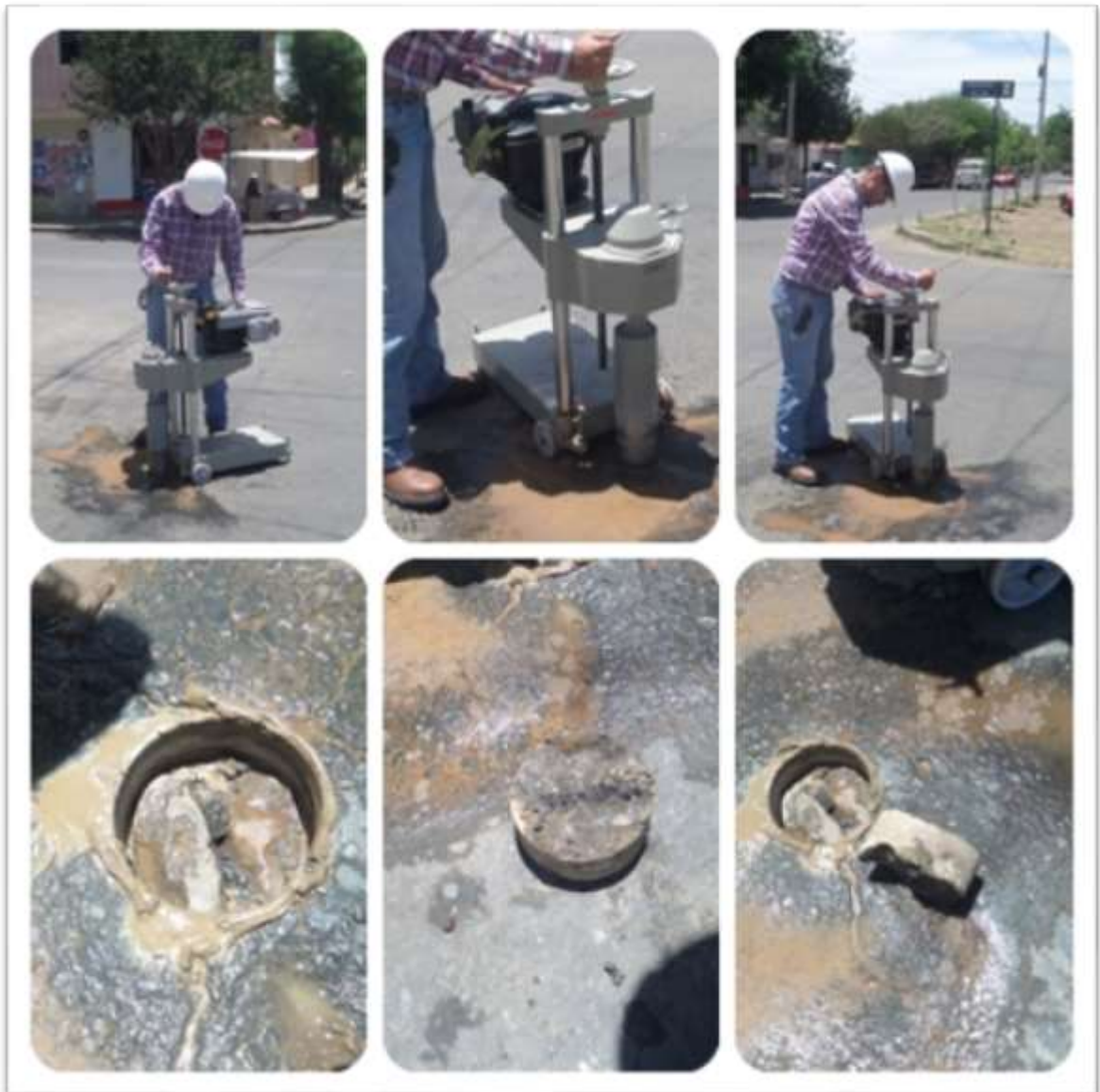
Fig. 3.4.2.3. Extracción de los núcleos del tipo Ampollas o Blisters
