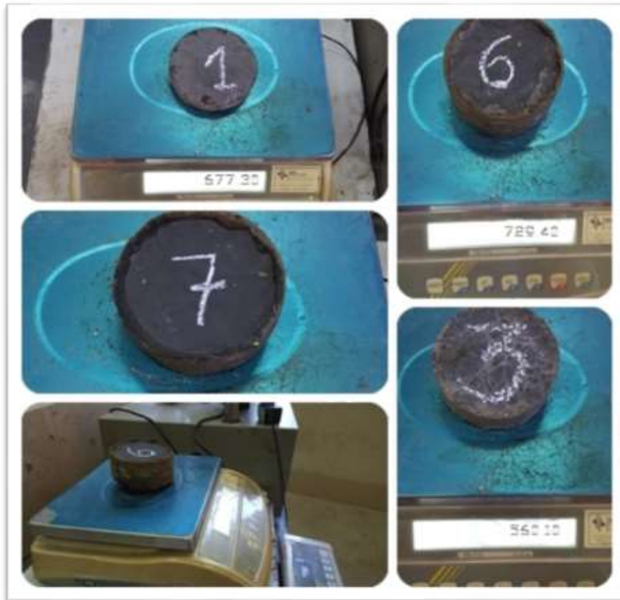
Fig. 3.4.4.1.1. Medición De Los Pesos En Seco De Cada Núcleo De Los Dos Tipos De Fallas
