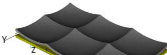
Figura 2.5: Alabeo en losas de concreto
