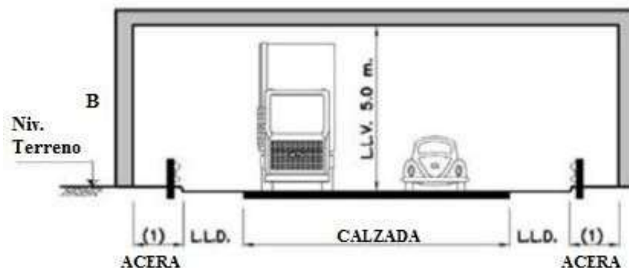
Figura 2.1 Luces libres laterales en calzadas
