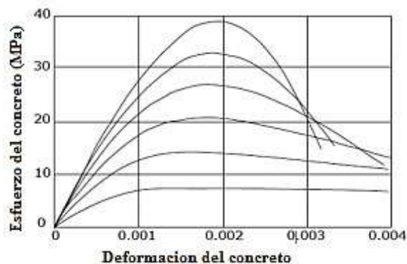
Figura 2.2 Curva Esfuerzo-Deformación del concreto en compresión
