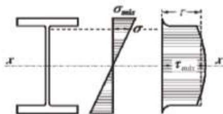
Figura 46. Esfuerzos en una Viga de alma llena
