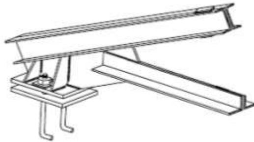
Figura 36. Detalle de estructura de techo con unión por medio de placa
