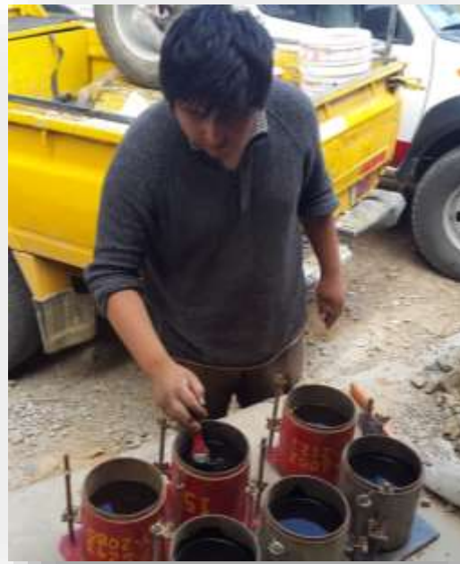
Figura 3.37 Esparcir Uniformemente La Emulsión Sobre Toda La Superficie
