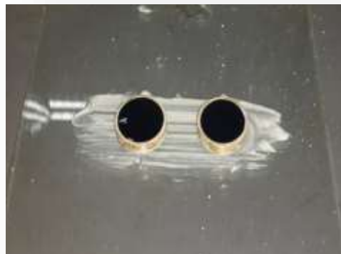
Figura 3.27 Muestras en Anillos Previamente Engrasados
