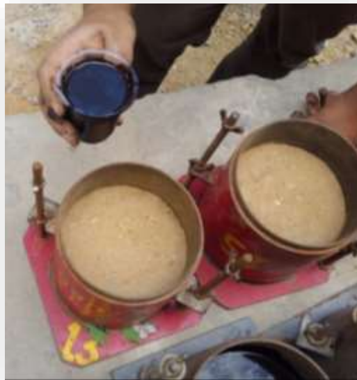
Figura 3.35 Riego De La Emulsion Asfaltica
