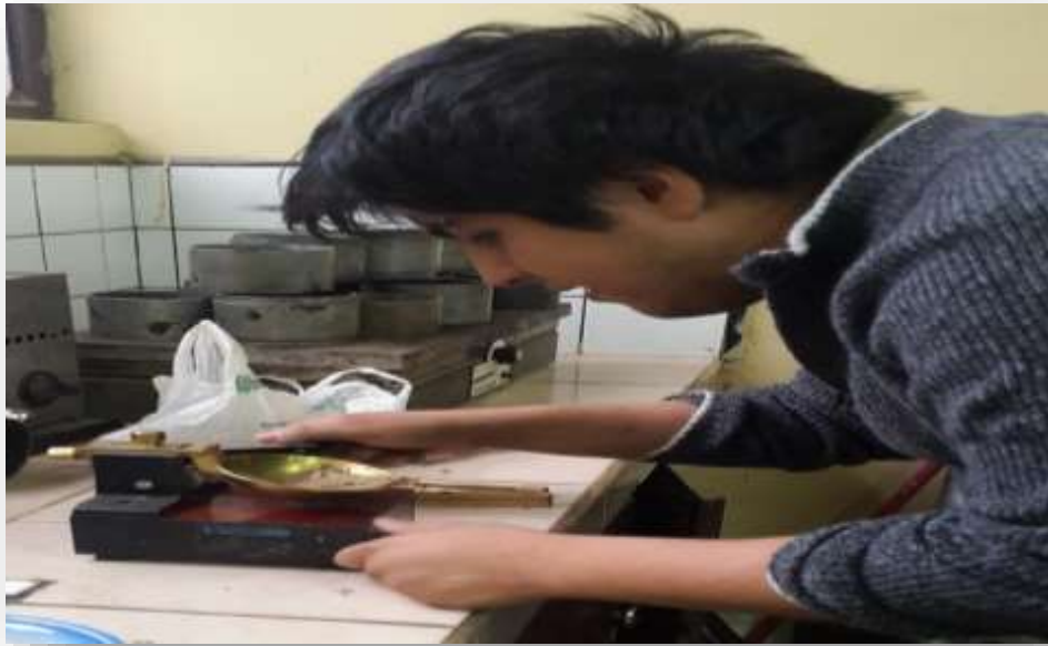
Figura 3.22 Analisis de las Muestras en el Equipo Casa grande
