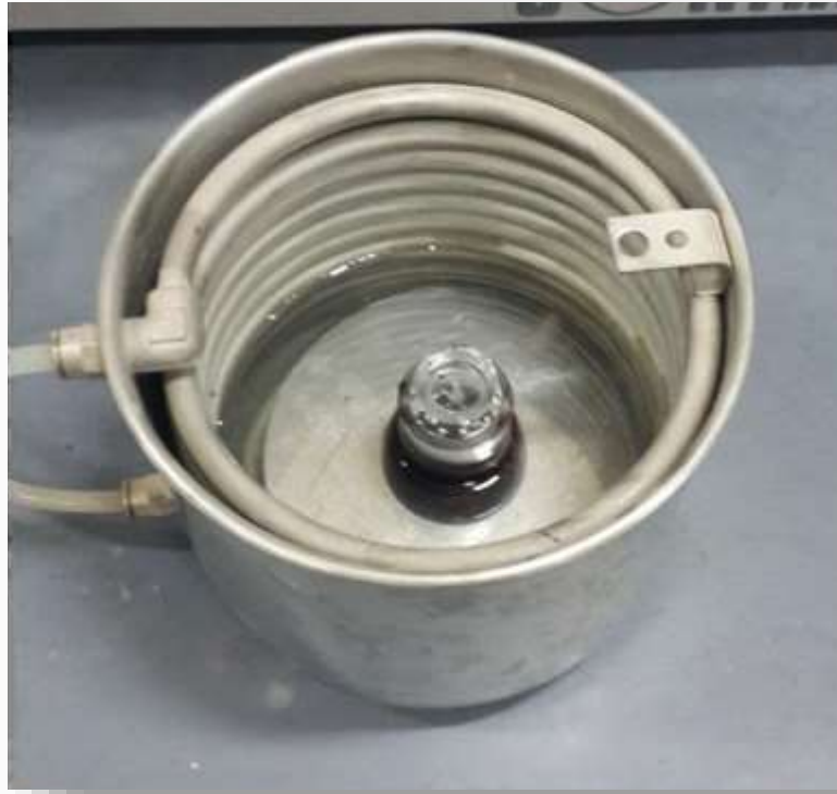
Figura 3.30 Muestra En Baño Maria Para Obtener El Peso Del Picnometro + Asfalto + Agua
