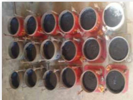
Figura 3.38 Primera Parte De Muestras Regadas De Capa Base Con Diferentes Tasas De Emulsion
