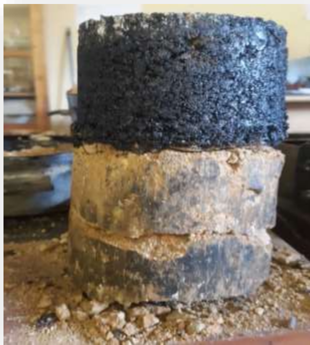
Figura 3.42 Probeta Despues De Realizado El Ensayo Lcb
