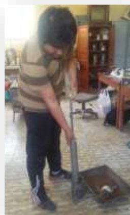
Figura 3.33 Compactado De La Capa Base En Molde T-99 Mediante Tres Capas Cada Una De 25 Golpes
