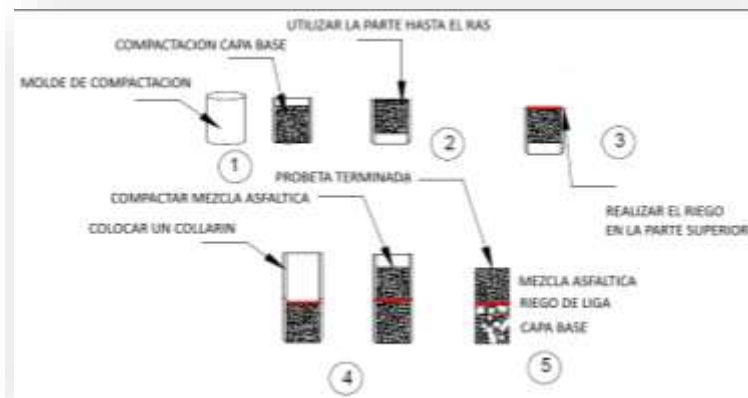
Figura 3.39 Esquema Fotografico De La Realizacion De La Probeta Completa
