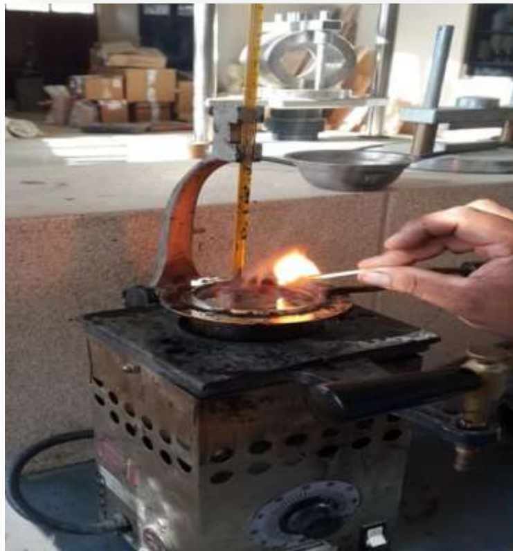
Figura 3.25 Destello de Llama a una Temperatura >260^{\circ}\text{C}
