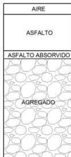
El espacio intergranular está ocupado por el asfalto y aire en una mezcla compacta denominada vacíos del agregado mineral (V.A.M.). Por lo tanto se define como la suma del volumen de aire y el volumen de asfalto efectivo expresado como un porcentaje del volumen total. El volumen de asfalto absorbido no es usualmente considerado como parte del V.A.M.
