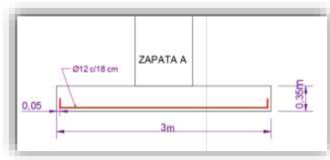
Figura N°29: Detallamiento de la zapata A
