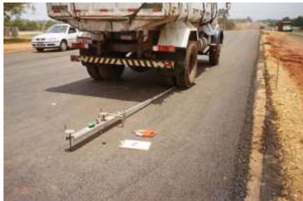
FIGURA 1. 4: CAMIÓN CARGADO Y DEFLECTÓMETRO BENKELMAN
