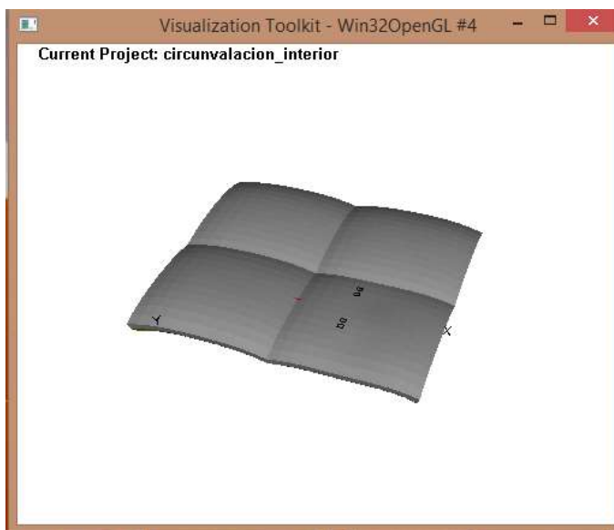
FIGURA 3. 34: GRÁFICA DE DESPLAZAMIENTOS EN EL INTERIOR DE LA LOSA
