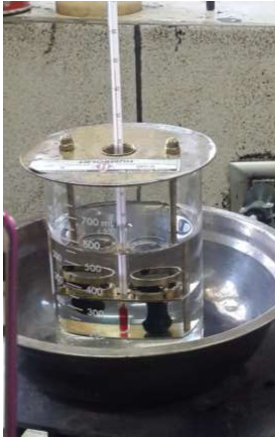
FIGURA N° 2. 7. Aparato de anillo y bola para determinar Punto de Ablandamiento
