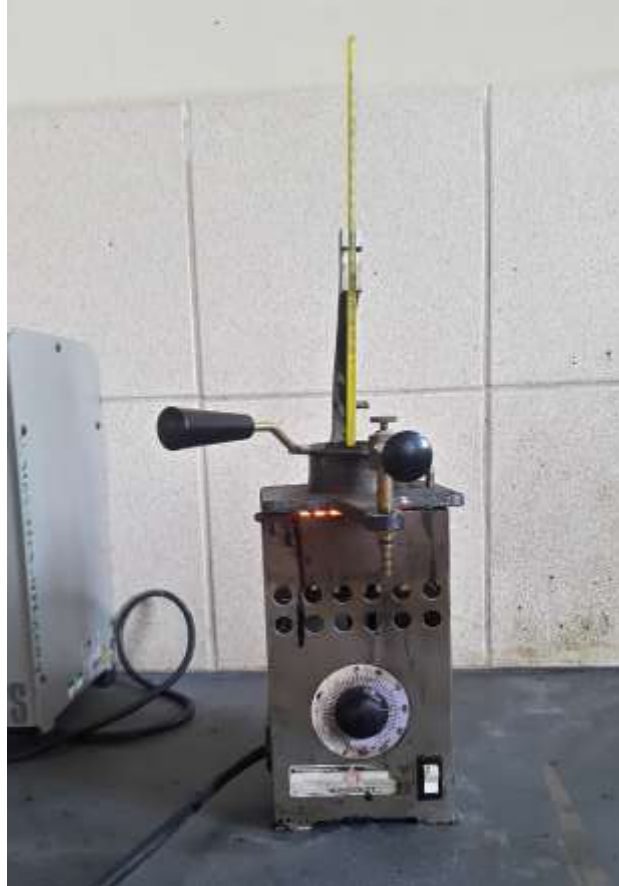
FIGURA N° 2. 6. Copa Cleveland para determinar Punto de Inflamación
