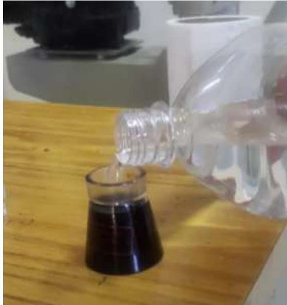
FIGURA N° 2. 3. Picnómetro con muestra de cemento asfáltico y agua destilada.
