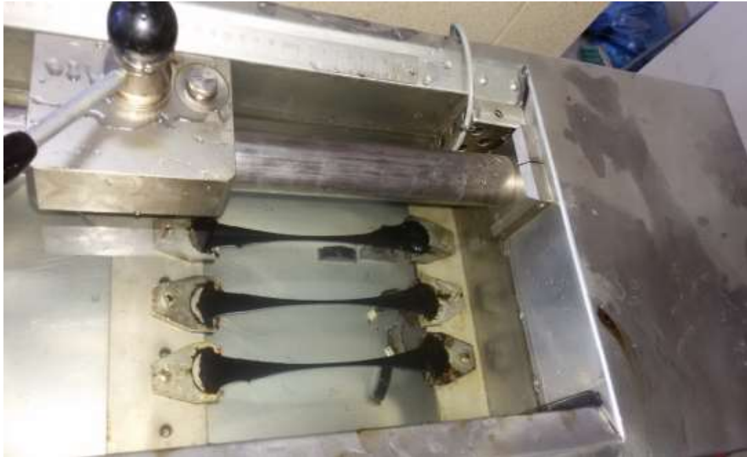
FIGURA N° 2. 14. Ensayo a tracción para asfaltos mediante ductilímetro.
