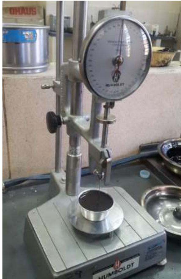
FIGURA N° 2. 2. Penetrómetro del laboratorio de asfalto para determinar la penetración.
