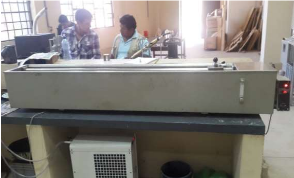
FIGURA N° 2. 4. Ductilímetro del laboratorio de asfaltos para determinar la Ductilidad
