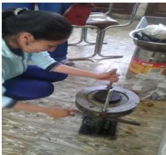
Imagen 4.8: Desmoldado de briquetas después de un reposo
