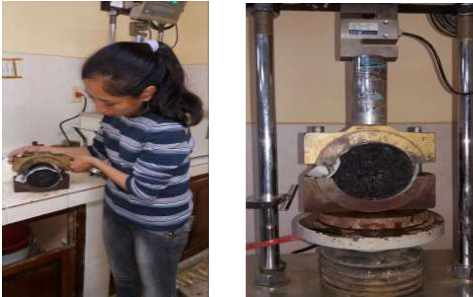
Imagen 4.10: Colocado de briquetas en la mordaza Marshall
