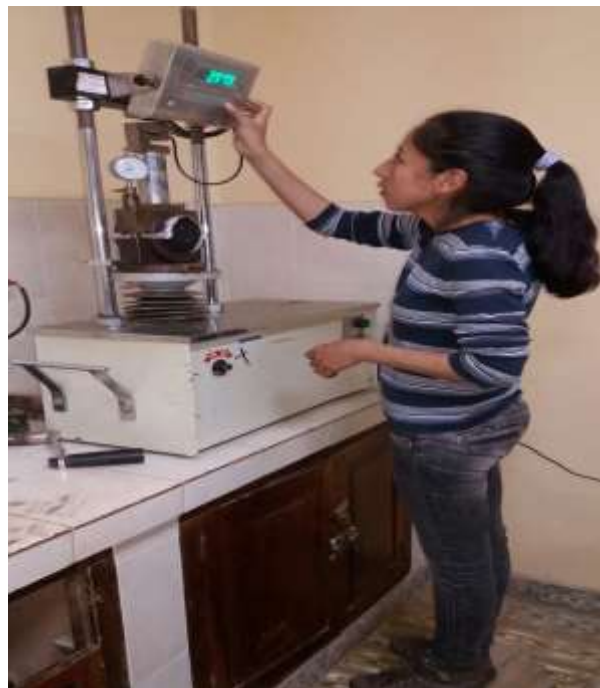
Imagen 4.11: Lectura del dial de Estabilidad (dentro del anillo Marshall) y el dial de deformación para el Flujo.
