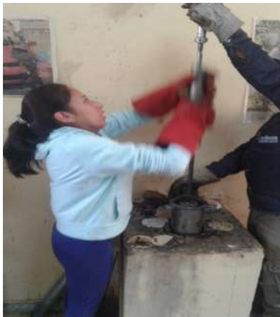
Imagen 4.7: Compactación con martillo con 75 golpes por cara.
