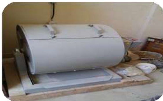
FOTOGRAFÍA 22. Máquina Desgaste de los Ángeles
