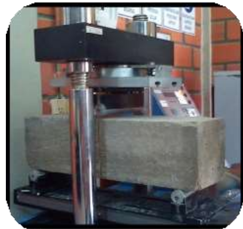
FOTOGRAFÍA 32. Rotura de Vigas
