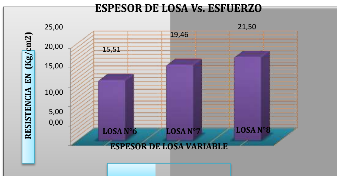
FIGURA 29.- Comparación de Espesores de losa Vs. Esfuerzo
