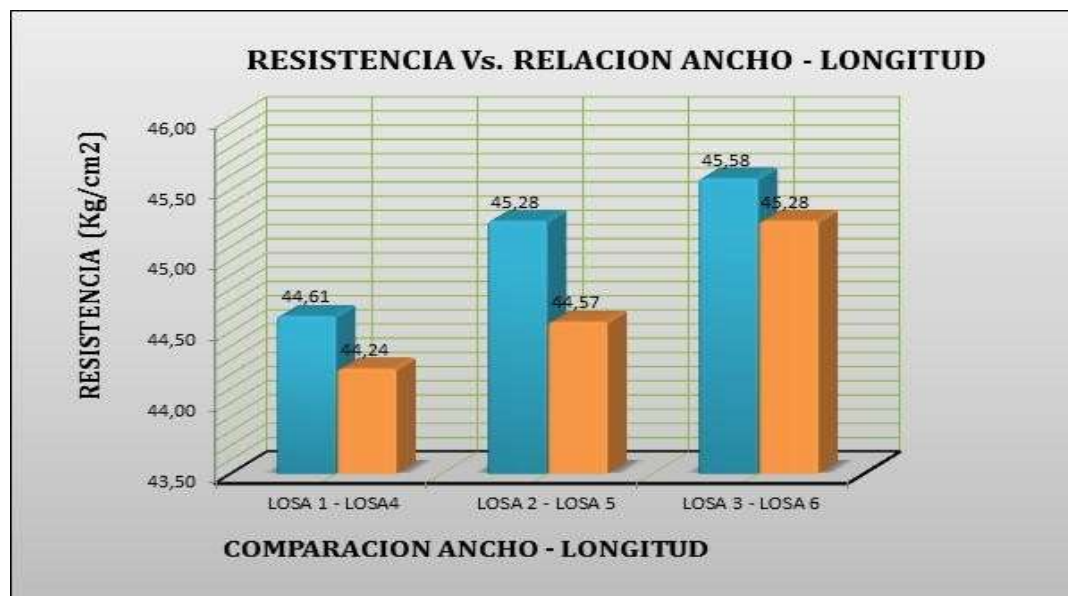
FIGURA 27.- Resistencia Relación Ancho vs. Longitud
