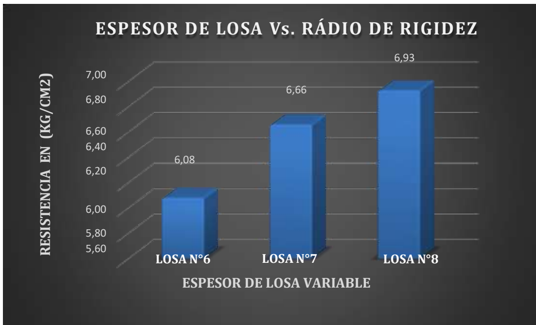
FIGURA 28.- Comparación de Espesores de losa Vs. Radio de Rigidez
