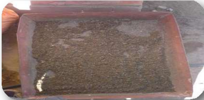
FOTOGRAFÍA 4. Cuarteo de Arena para Granulometría
