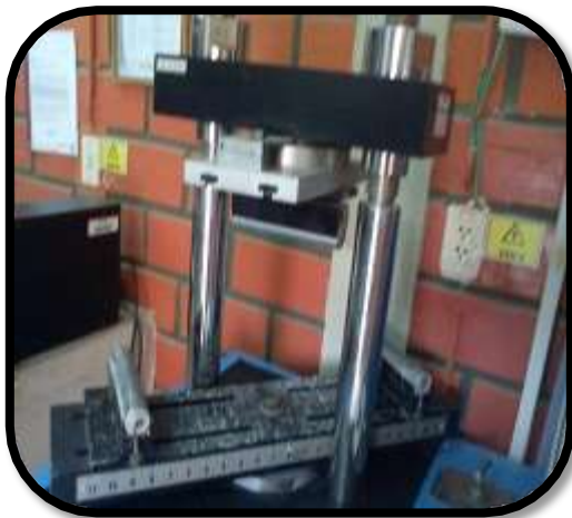
FOTOGRAFÍA 31. Máquina con Carga Centrada
