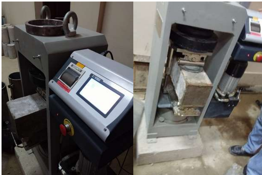
Foto N° 22, Maquina con Carga Centrada para la Rotura de los Moldes.
