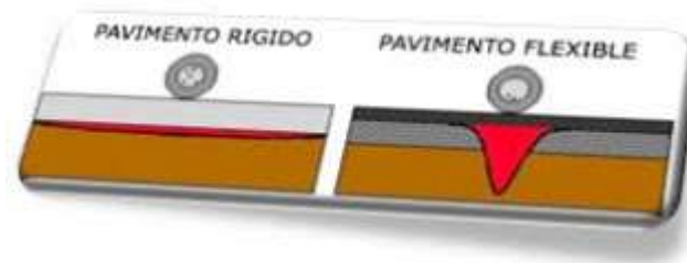
FIGURA N° 3 , Diagrama de Esfuerzo en Pavimento Rígido y Flexible.
