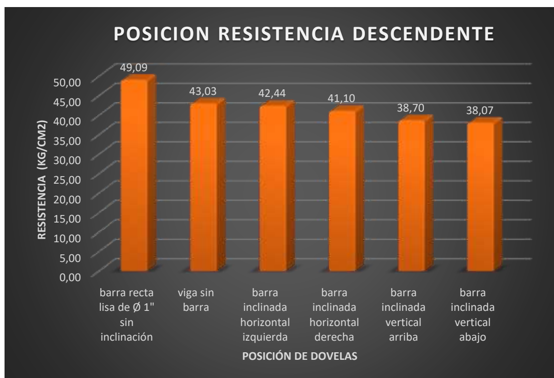
Figura N° 50 , Resistencia de Vigas en Función a la Desviación de las dovelas en orden descendente en 4 posiciones y 1 viga sin barra de transferencia.
