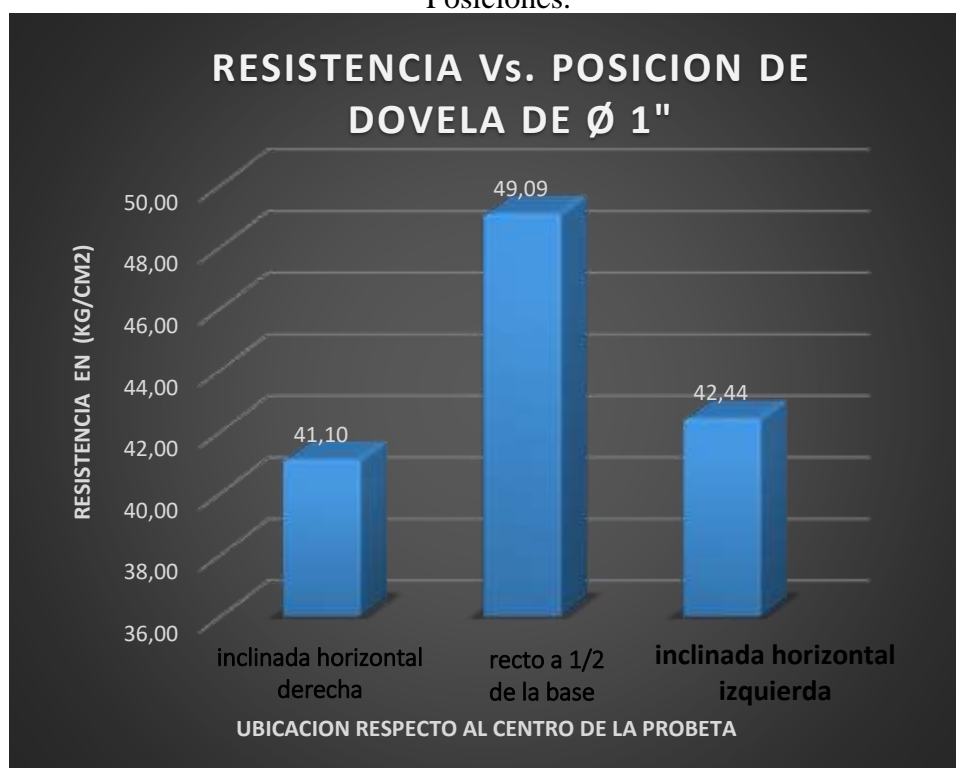
Figura N° 46 , Comparación de Resistencia de la Barra de D= 1” en sus tres Posiciones.
