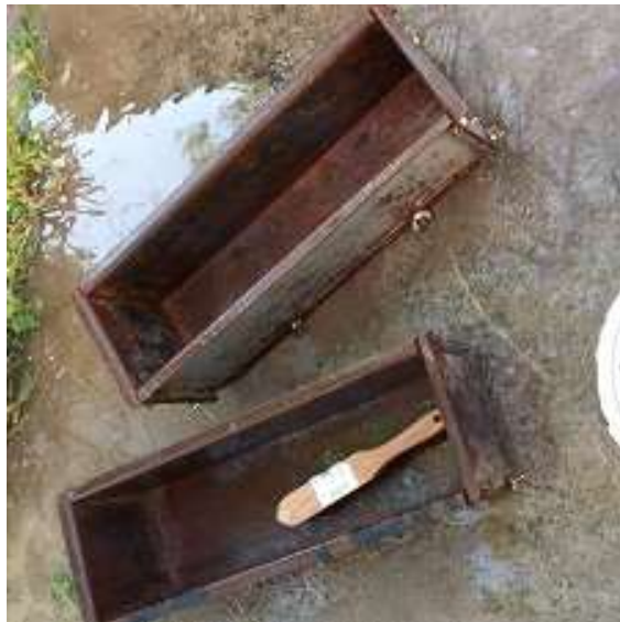
Foto N° 21, Cepillado y Limpieza de Moldes.
