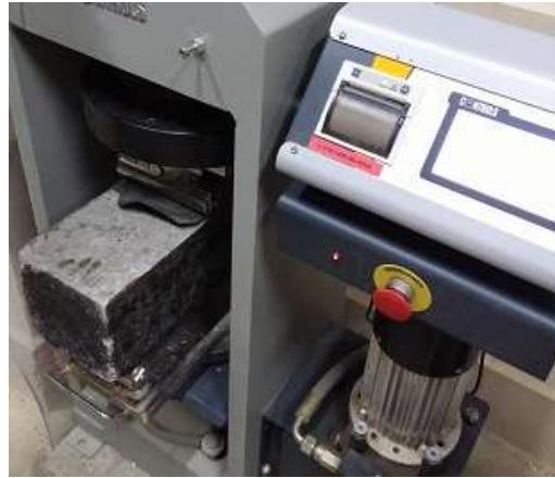
FOTO N° 23, Ubicación de Carga y Fisuras.
