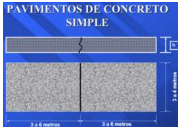
FIGURA N° 4, Pavimento de Concreto Simple.
