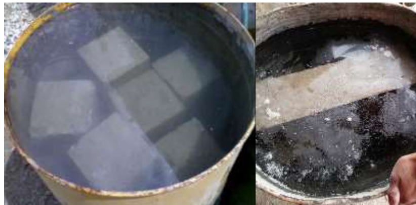
Foto N° 19, Curado de Probetas de Hormigón.
