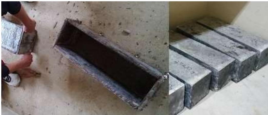
Foto N° 18, Desmolde de Probetas para posterior Ensayo a Flexión.
