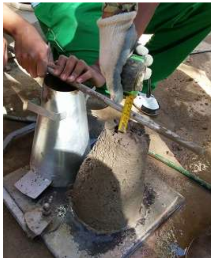
Foto N° 13, Revenimiento realizado con el Cono de Abrams .
