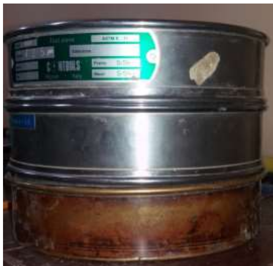
Figura 3.7.- Tamizando lo que queda en la malla N°200
