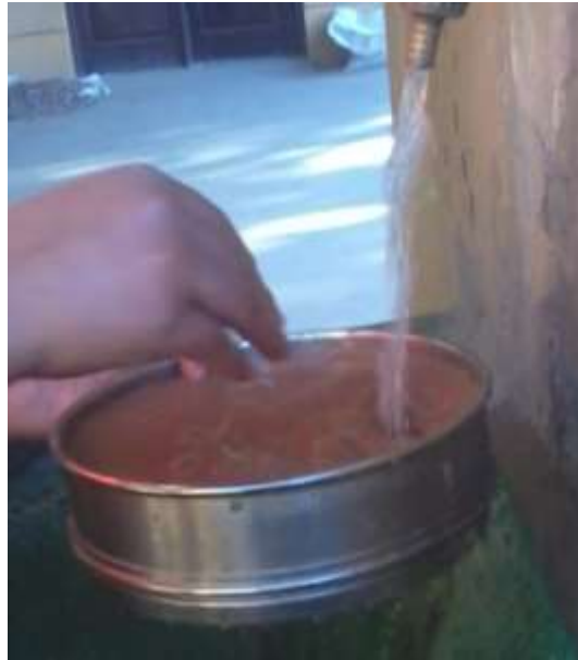
Figura 3.6.- Lavando el suelo por la malla N°200
