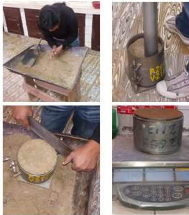
Figura 3.9: Ensayo de compactación
