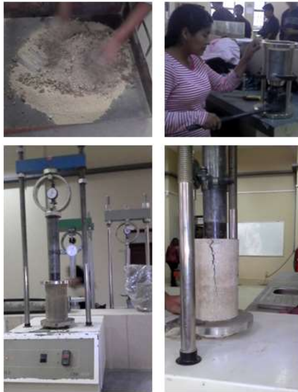
Figura 3.11: Realización del ensayo de compresión confinada
