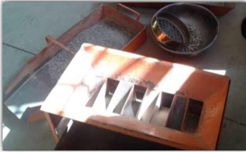
FIGURA 3. 69 Separando las partículas planas o alargadas
