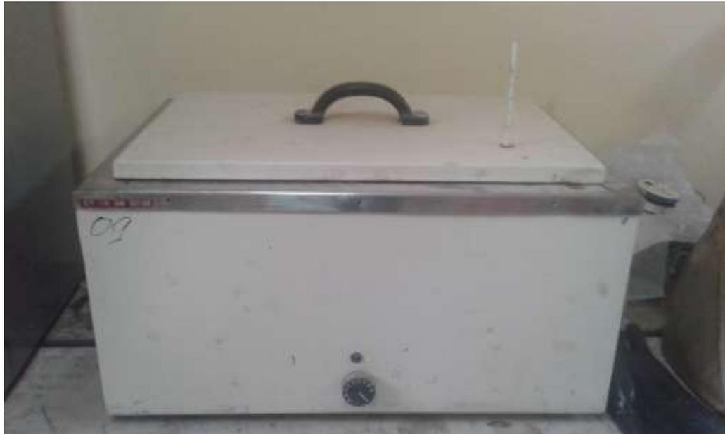
FIGURA 3. 60 Extracción de briquetas en baño María al equipo Marshall.
