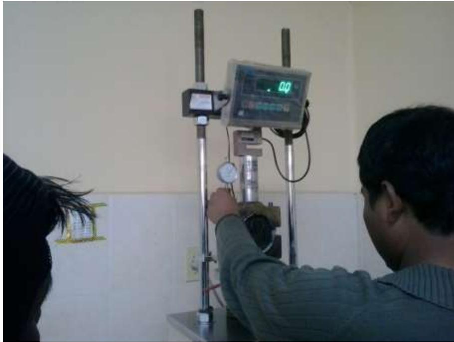
FIGURA 3. 63 Lectorado de flujo y Estabilidad de probeta.
