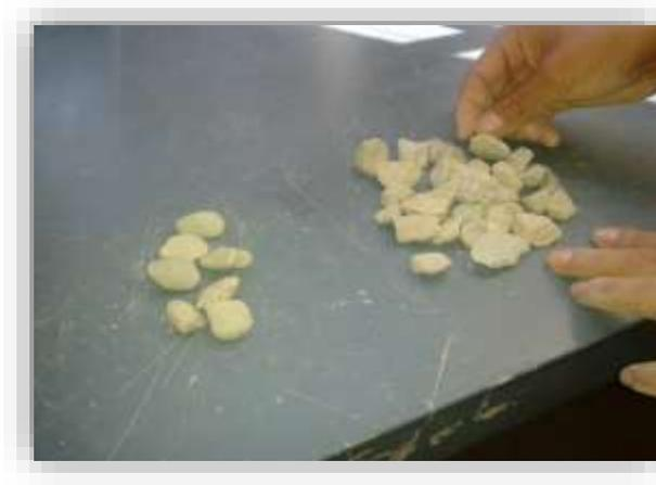
FIGURA 3. 67 Peso de partículas fracturadas
