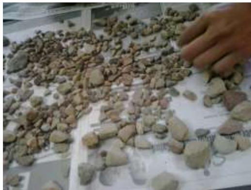
FIGURA 3. 66 Inspección y detección de las partículas fracturadas.
