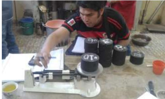
FIGURA 3. 57 Peso sat. Superf. Seco
