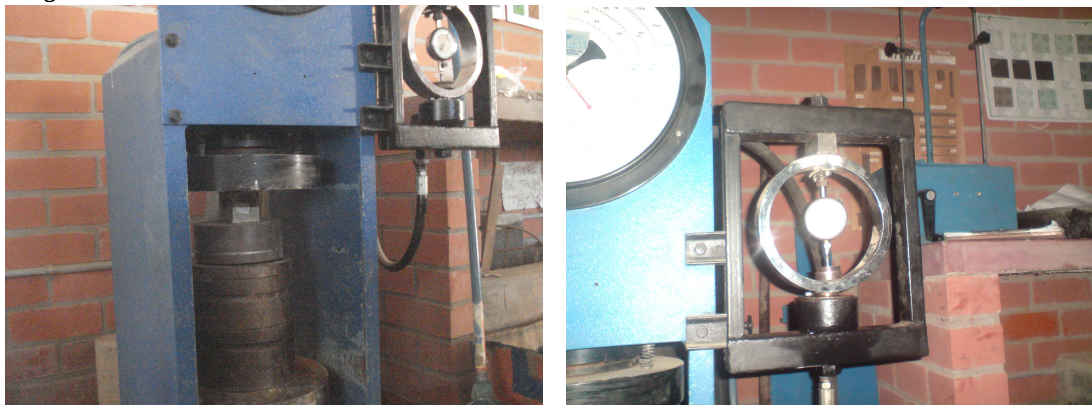
Figura IV- 27: Prensa Hidráulica Para Pruebas De Resistencia A La Compresión Del Laboratorio De Suelos Y Hormigones De La UAJMS
