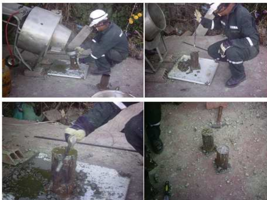
Figura IV- 30: proceso del Mezclado y vaciado de probetas de Hormigón a Base de Azufre
