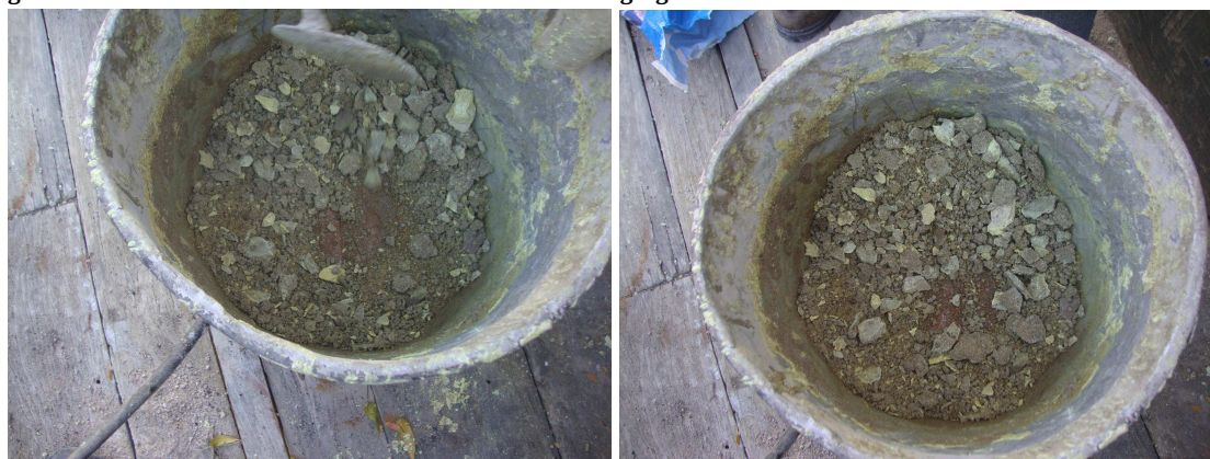
Figura IV- 51: Mezclado del Azufre Modificado con los Agregados
