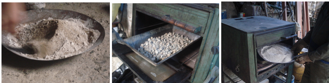
Figura IV- 28: Mezclado de la Arena con la Ceniza Volcánica y posterior Calentamiento De Los Agregados en horno.
