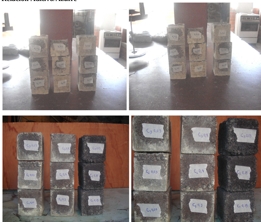
Figura IV- 7: Acabados De Probetas De Mortero A Base De Azufre Codificadas De Acuerdo al tipo De Aditivo Utilizado Y Su Relación Aditivo/Azufre
