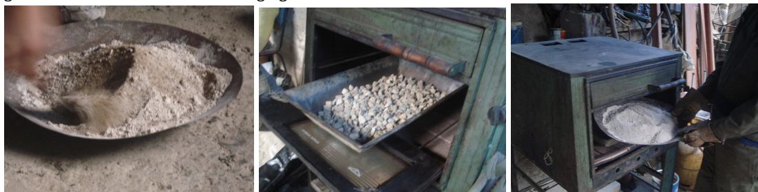
Figura IV- 47: Calentamiento de los Agregados en el Horno
