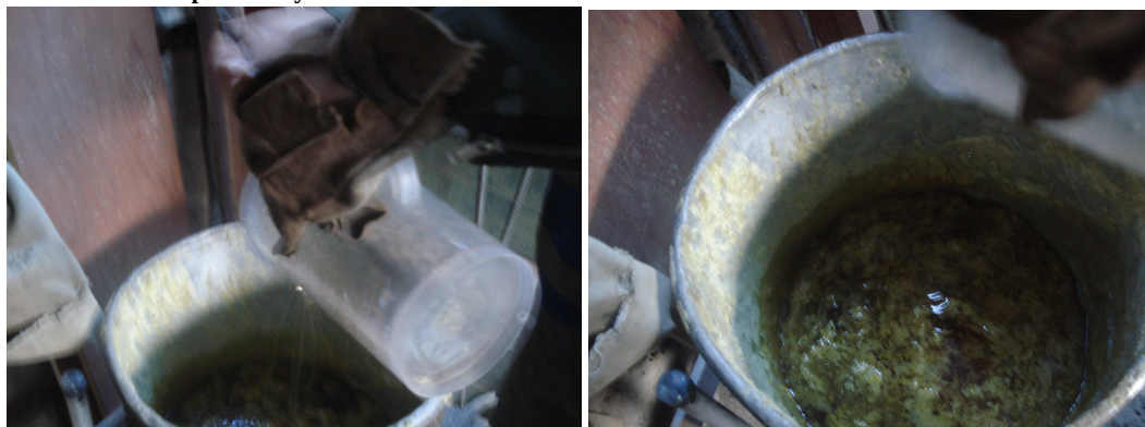
Figura IV- 50: Incorporación y Mezclado del Aditivo en el Azufre Fundido
