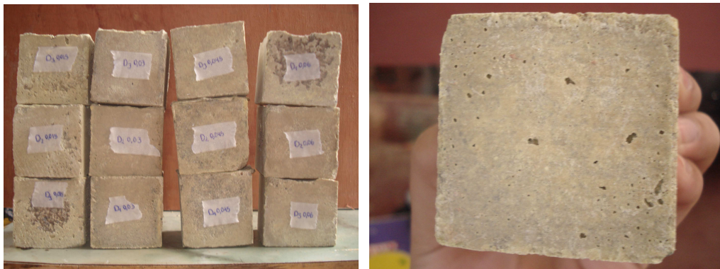
Figura IV- 15: Acabados De Probetas De Mortero A Base De Azufre Con Llenante De Ceniza Volcánica Más El Aditivo “A” a Una Relación Adit/Azuf de 0.05
