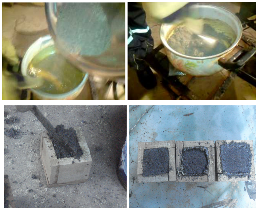
Figura IV- 6: Mezclado y vaciado de probetas cúbicas con morteros a base azufre
