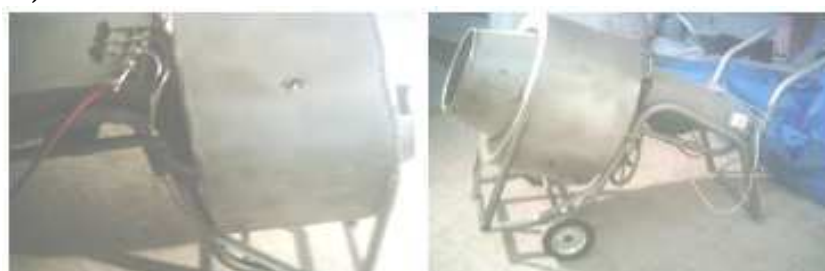
Figura IV- 20: Sistema De Calentamiento De La Mezcladora (Izquierda) Y Forro De Fibra De Vidrio (Derecha)
