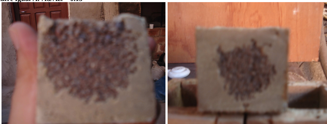
Figura IV- 8: Probeta Cúbica De Mortero A Base De Azufre Modificado Con El Aditivo B A Una Relación Aditivo Azufre Igual A: Ad/Az. = 0.15
