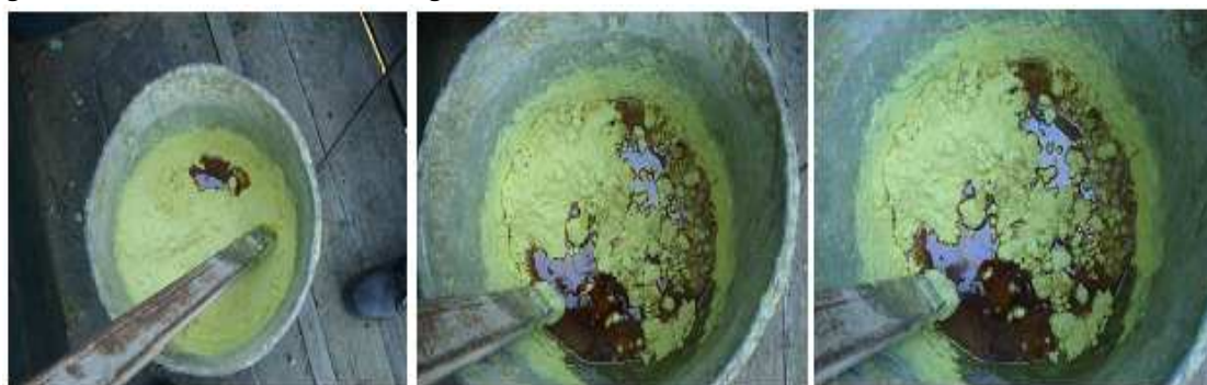
Figura IV- 48: Fundido del Azufre a fuego lento en una olla
