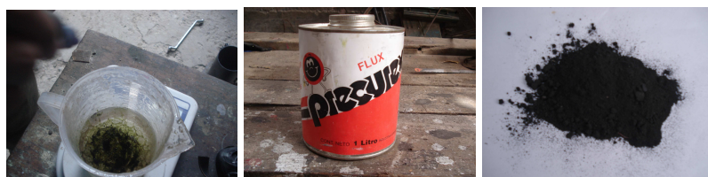
Figura III- 5: Aditivos Modificadores del Azufre (Resina de poli estireno izquierda, Flux de goma centro, Caucho derecha)
