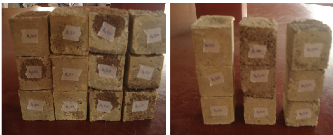
Figura IV- 13: Acabados De Probetas De Mortero A Base De Azufre Con Llenante De Ceniza Volcánica Más Aditivos (izquierda aditivo A, derecha aditivo B)
