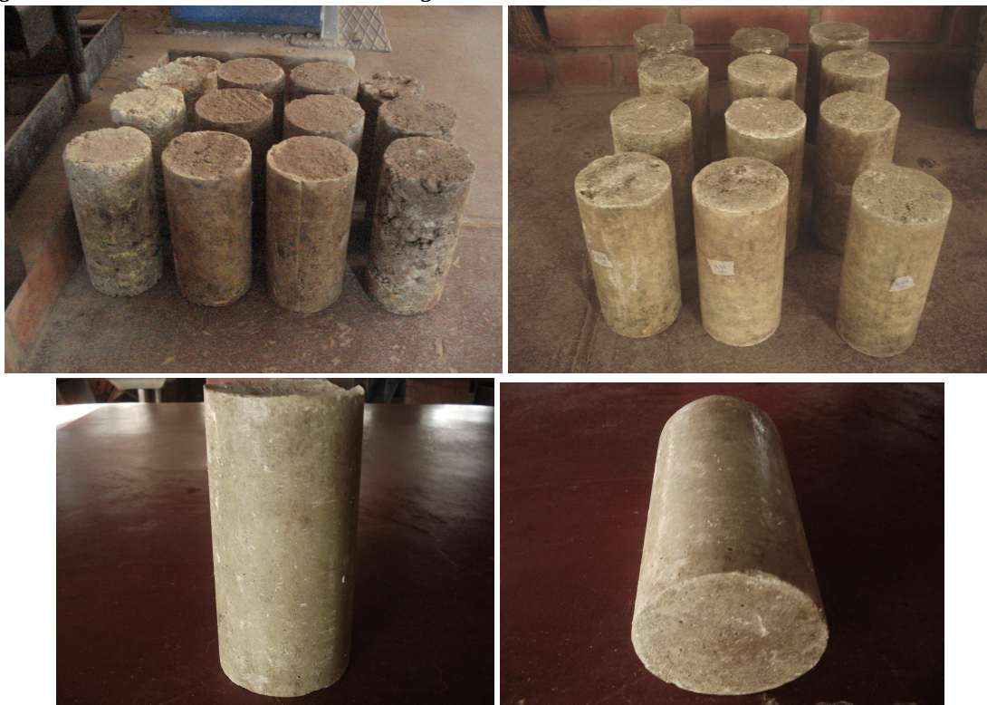
Figura IV- 31: Acabados De Probetas De Hormigón a Base de Azufre con distintas dosificaciones
