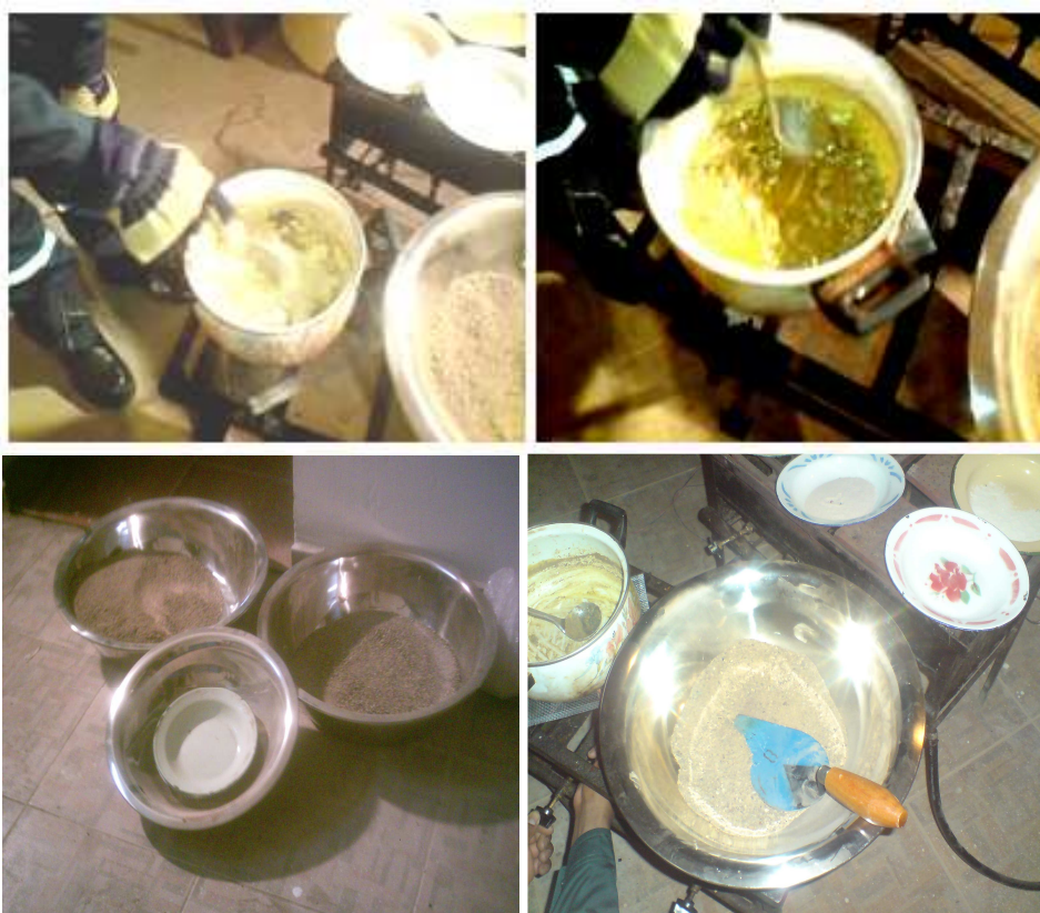
Figura IV- 5: Calentamiento De La Arena Y El Azufre Para Elaboración De Morteros A Base De Azufre
