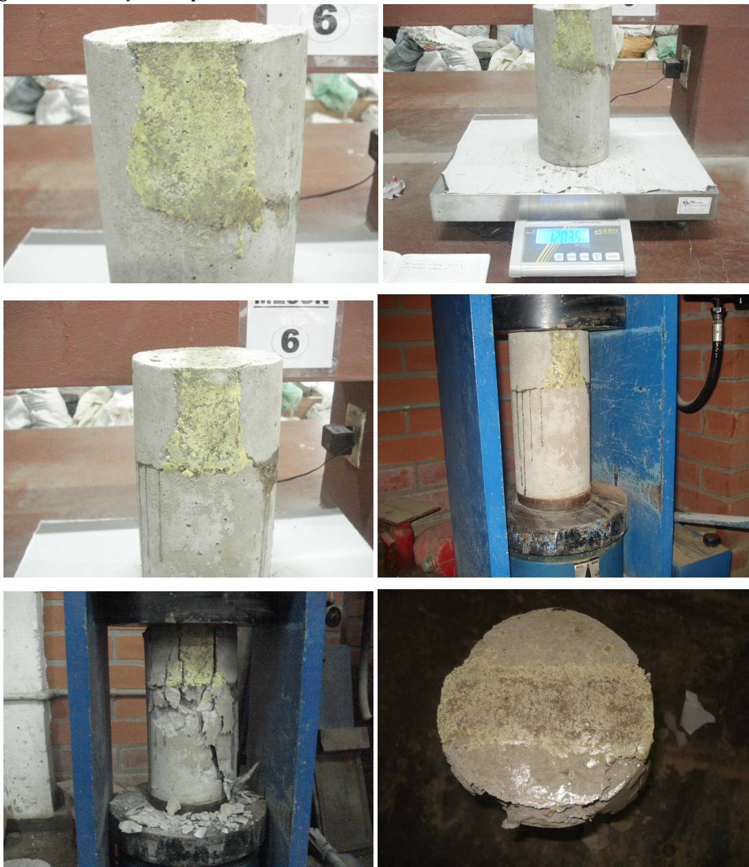
Figura IV- 39: Ensayo a Compresión de las Probetas Selladas con Mortero de Azufre
