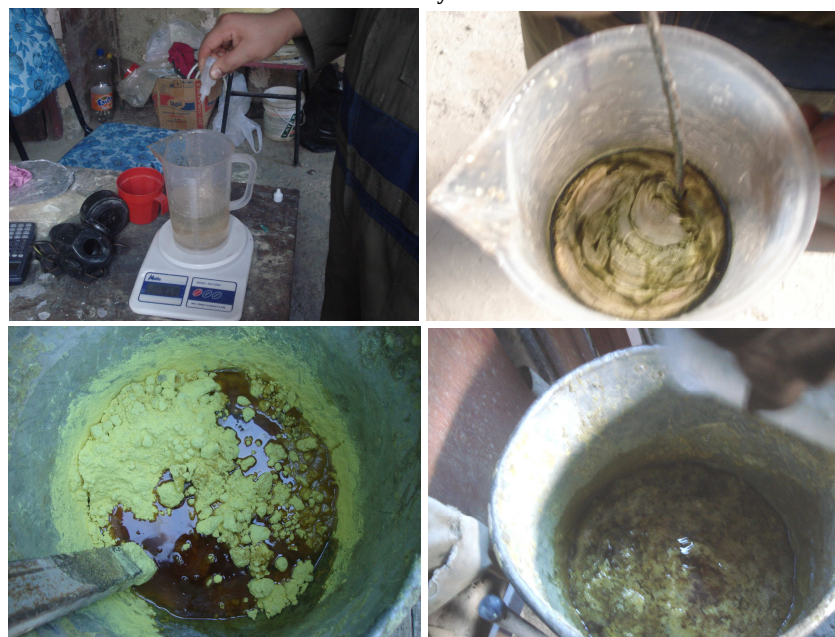
Figura IV- 29: Mezclado del aditivo con los catalizadores y fundición del Azufre Modificado
