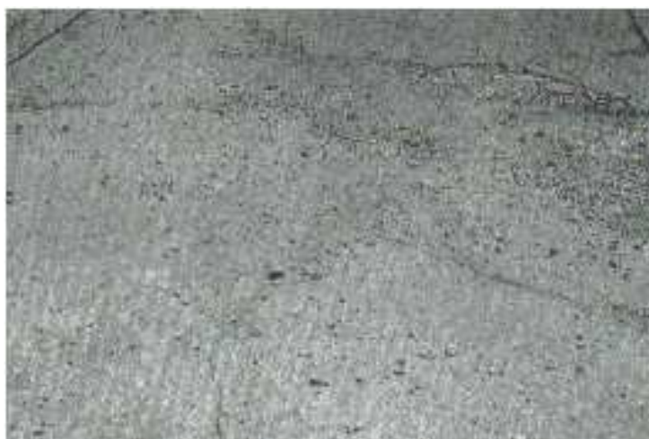
Figura II- 56: Grieta de durabilidad de alta severidad.
