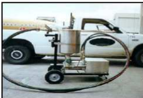
Figura II- 68 Equipo Aplicador de dos componentes
