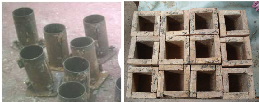
Figura IV- 22: Moldes De Forma Cilíndrica, De 10 cm De Diámetro Y 20 cm De Altura.
