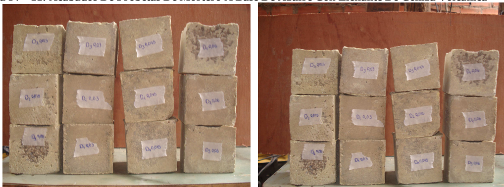
Figura IV- 11: Acabados De Probetas De Mortero A Base De Azufre Con Llenante De Ceniza Volcánica
