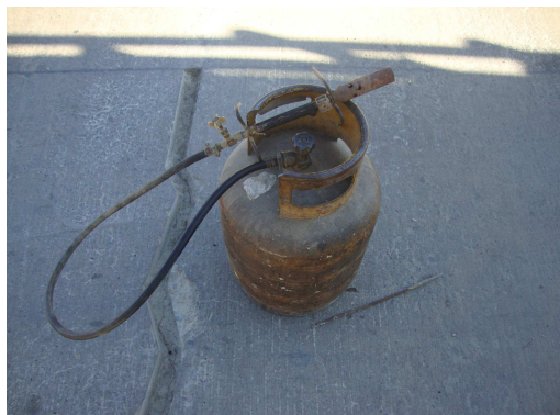
Figura IV- 37: Equipo para el Ruteado de l elemento a Sellar
