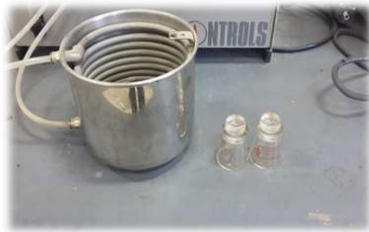
Figura 1.10 Instrumento para determinar Peso Específico
