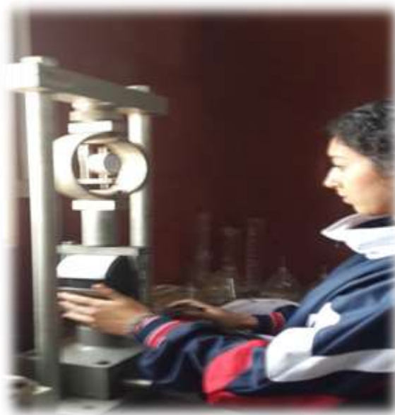
Figura 4.13 Briqueta en Prensa Marshall
