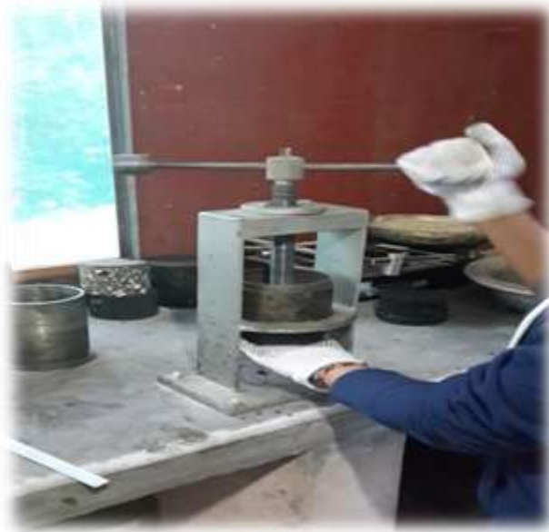
Figura 4.8 Desmolde de briquetas una vez frías
