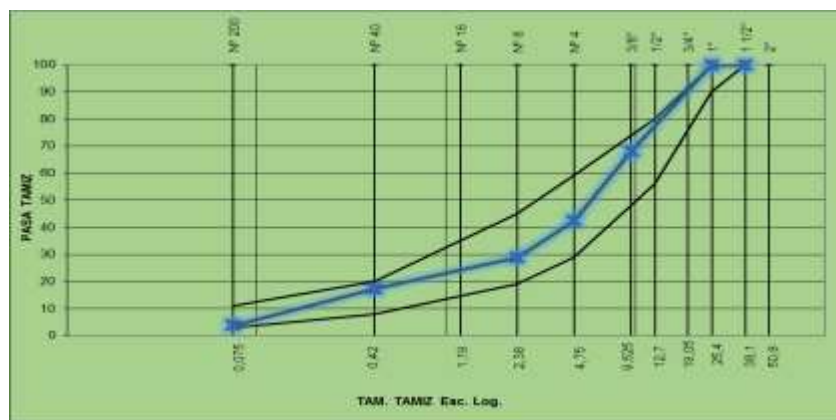
Grafica 3.1 Curva Granulométrica (Agregado: Chancadora Lagunitas)
