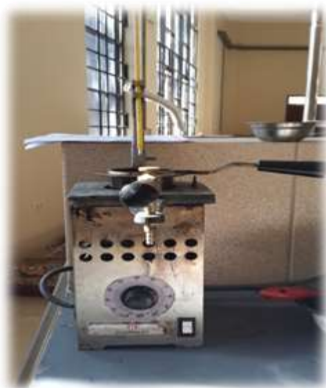
Figura 1.7 Copa abierta de Cleveland para determinar Punto de inflamación
