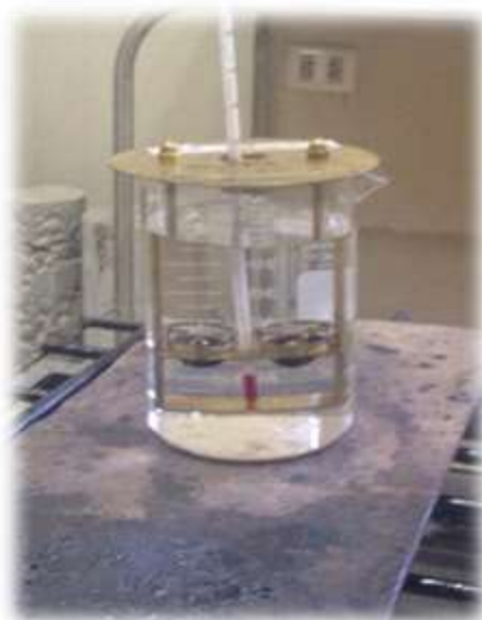
Figura 1.8 Aparato de anillo y bola para determinar Punto de Ablandamiento
