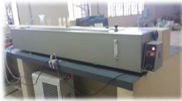
Figura 1.9 Ductilimetro para determinar Ductilidad
