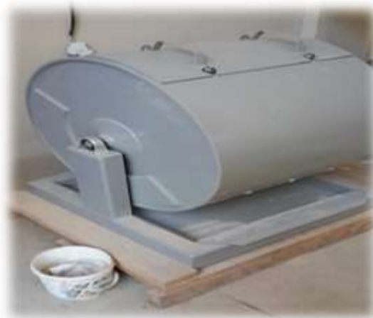
Figura 1.4 Tambor para el ensayo al desgaste de los ángeles
