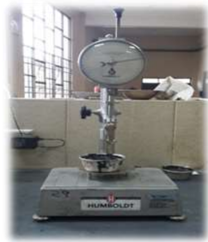
Figura 1.6 Penetrómetro para determinar la penetración
