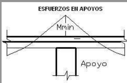
Fig. 6.12.3.2 Esfuerzos en Apoyo de losas
