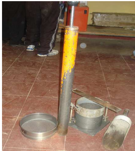
Figura Nro. 4 Equipo usado para la Prueba Proctor Modificada
