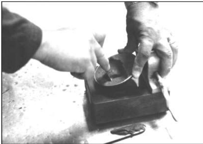
Imagen 3.1 Aparato de Casagrande
