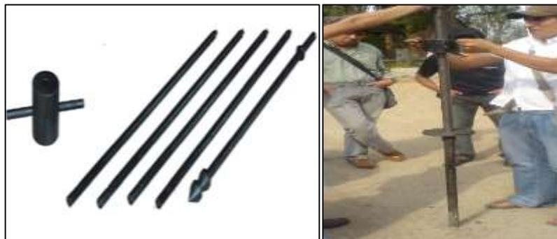
Ilustración 3: Equipo Ensayo Cono Dinámico Tipo HOLANDES
