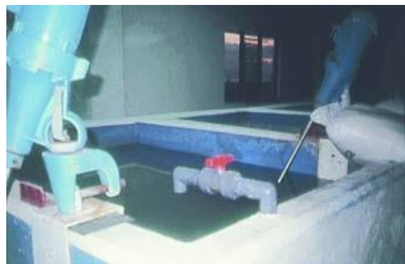
Figura 3.13 Tanque de preparación de la solución
