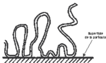
Figura 3.2 Esquematación de los polímeros adsorbidos en la superficie de coloides
