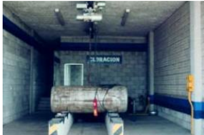
Figura 3.69. Forma de almacenar cilindros de una tonelada
