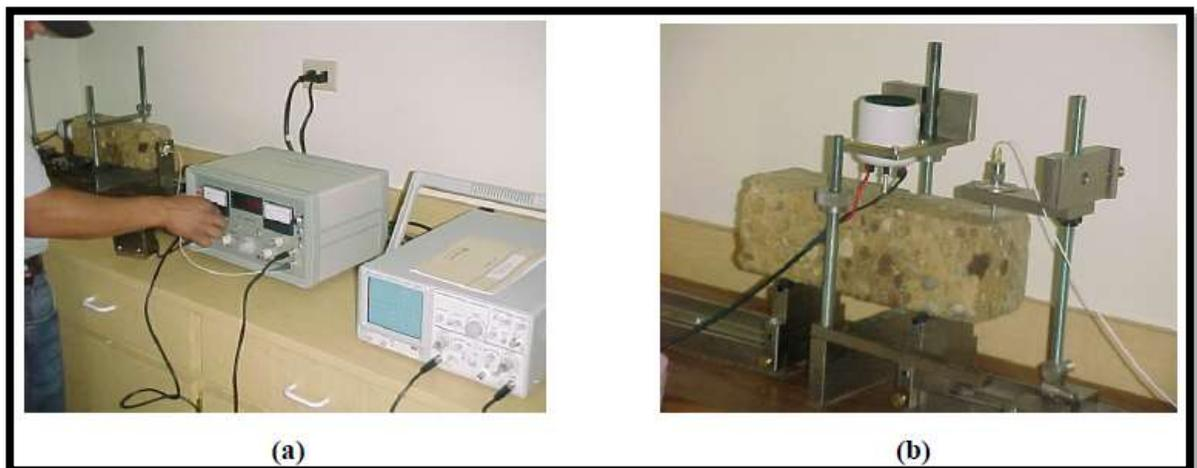
*Figura 2.4 (a) y (b) Frecuencia Resonante para la determinación de módulos de elasticidad en muestras inalteradas de Suelo Cemento*
