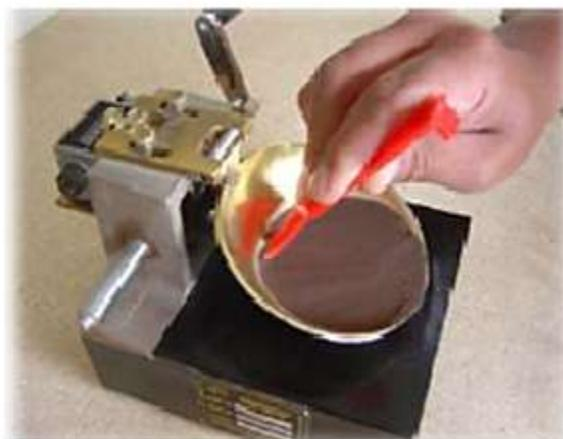
***Figura 3.30 Utilización del Ranurador ASTM***
