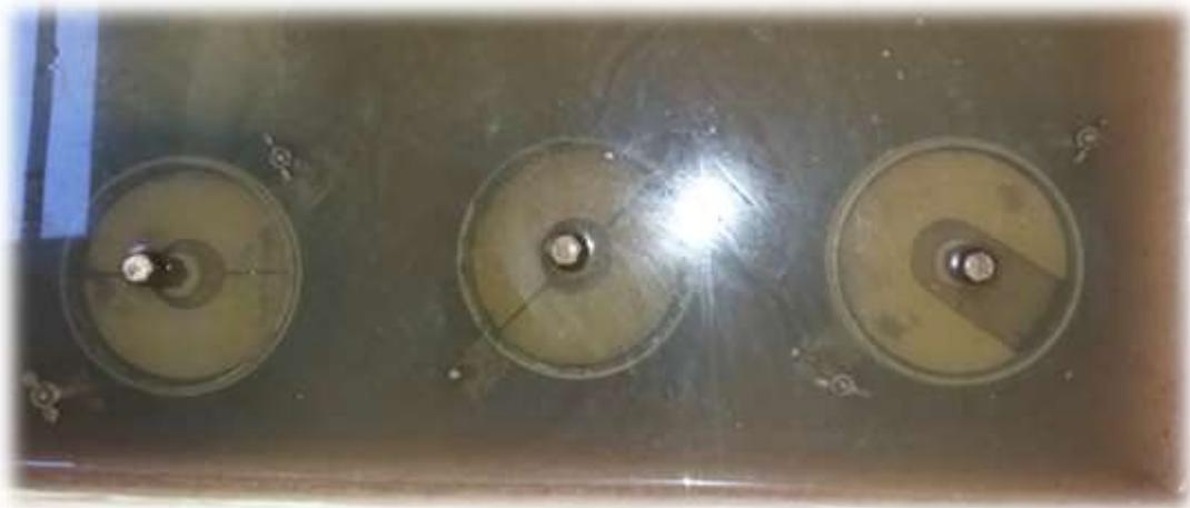
***Figura 4.62 Muestras Suelo Cemento Saturadas***
