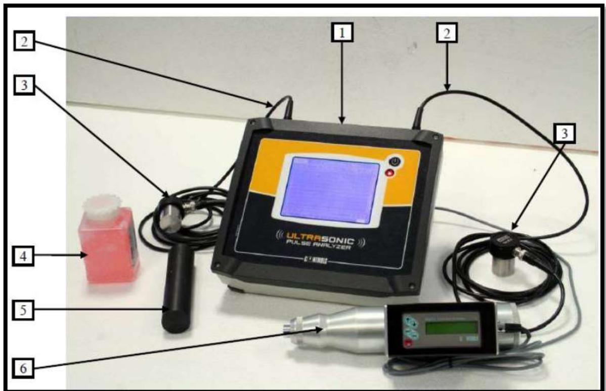
**Figura 4.51** Equipo utilizado en el ensayo de pulso ultrasónico
