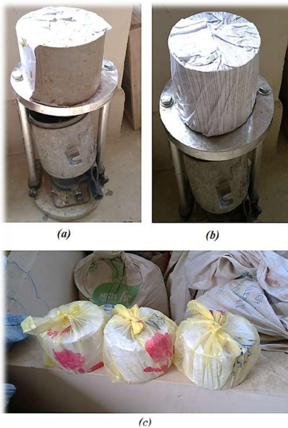
**Figura 4.47 (a) y (b) Confinamiento de las Probetas por medio de papel húmedo (c) Confinamiento sobre el papel húmedo con bolsas de plástico bien cerradas**
