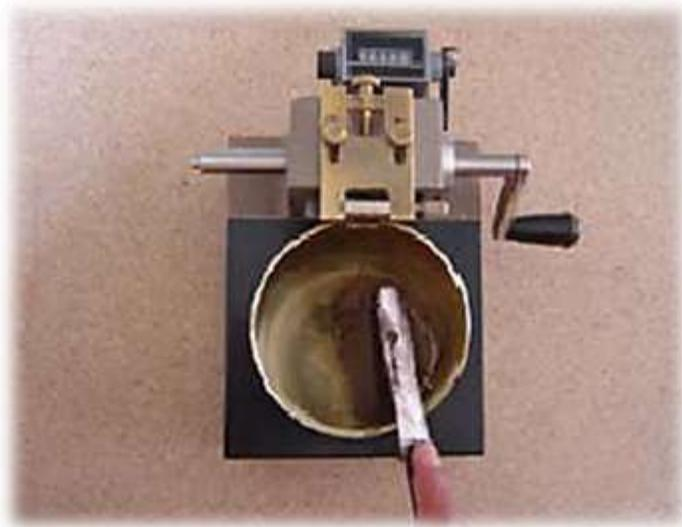
*Figura 3.28 Colocación de la muestra en la copa de Casagrande*
