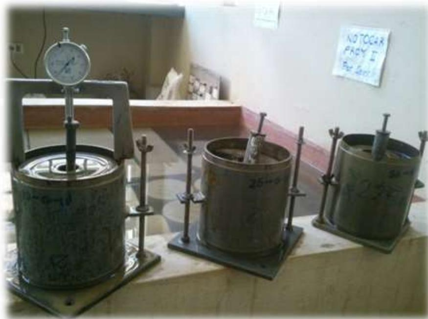
***Figura 4.63 Lecturación de la Expansión de la muestra mediante el Extensómetro***
