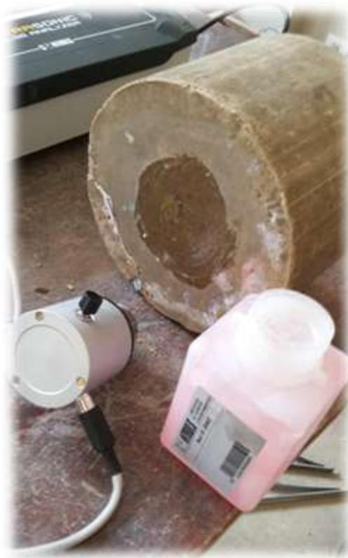
***Figura 4.54 Engrasado de superficies laterales de las Probetas***
