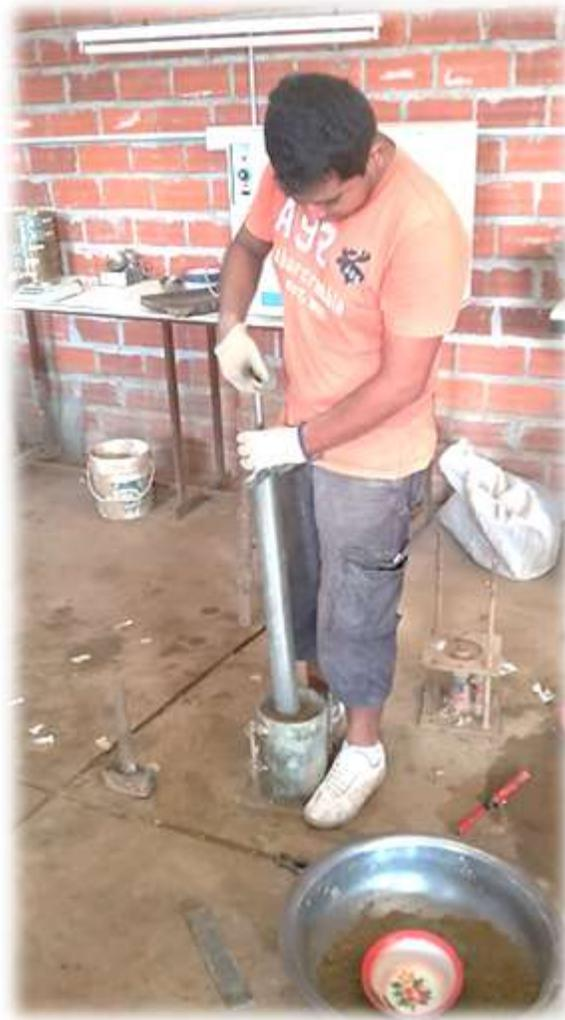
***Figura 4.44 Elaboración de probetas de Suelo Cemento***
