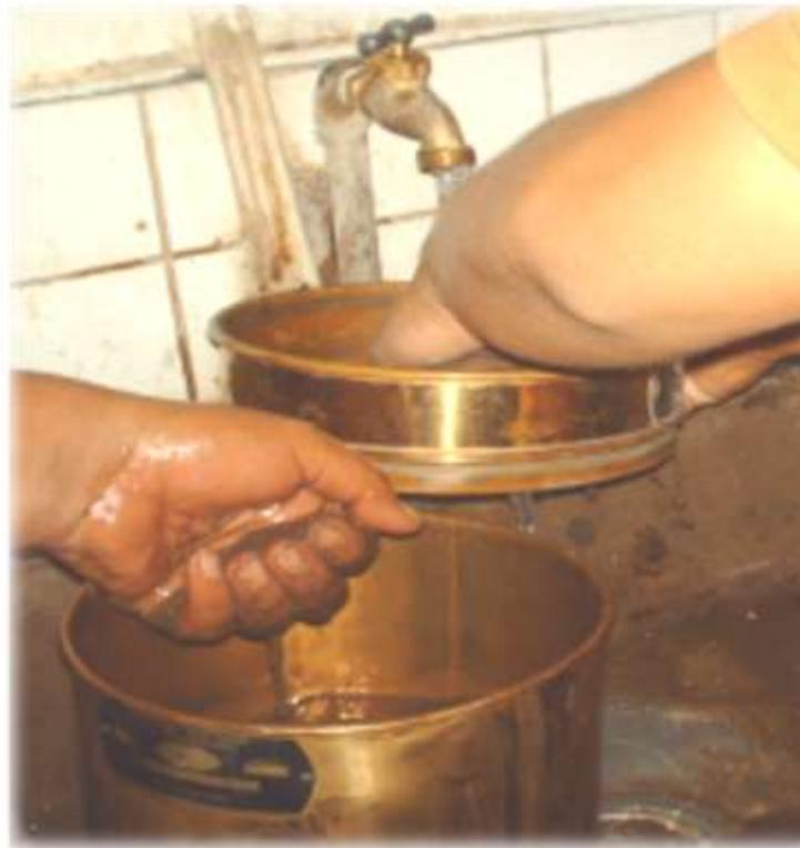
*Figura 3.25 Lavado del material en el ensayo de granulometría por malla N° 200.*
