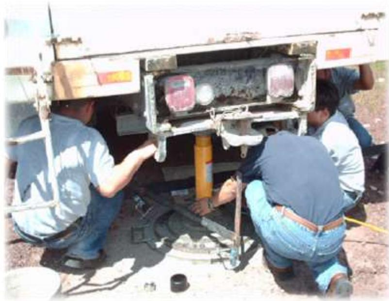
*Figura 2.6 Equipo utilizado en la realización de prueba de placa de carga*
