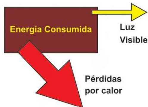
Figura 3.16 Rendimiento de una lámpara incandescente
