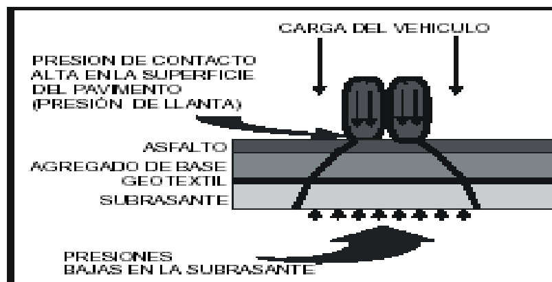
Fig. 2-16 Función de Separación
