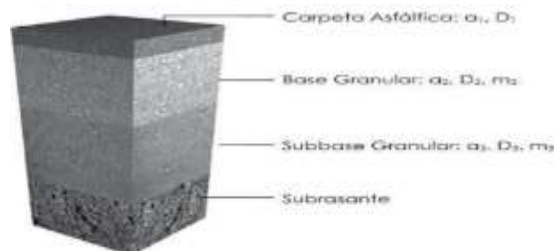
Fig. 3-11 Sección de la estructura con sus respectivos Coeficientes de capa.
