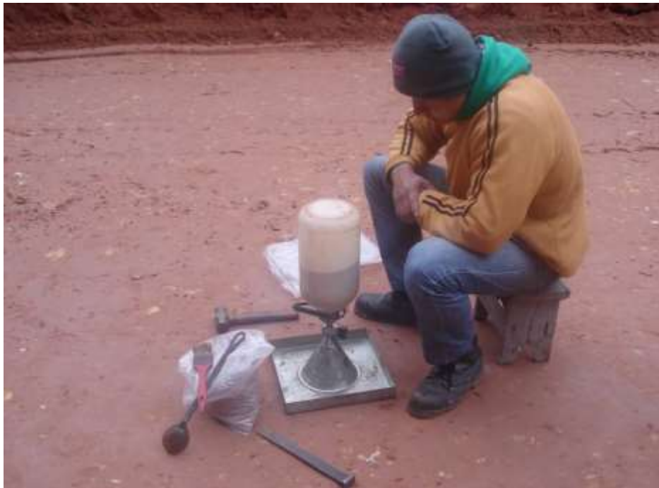
Figura 4.15. Control tecnológico de densidades método del cono.
