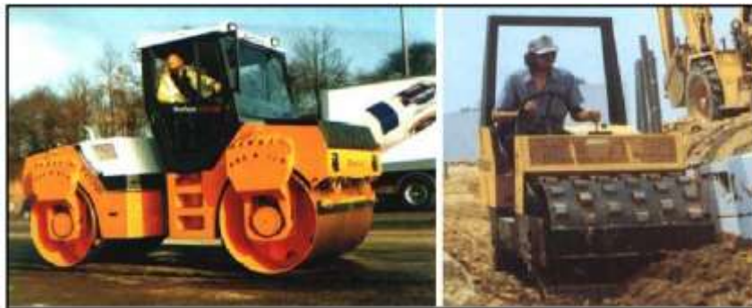
MAQUINARIA DE COMPACTACIÓN DE TERRAPLENES
