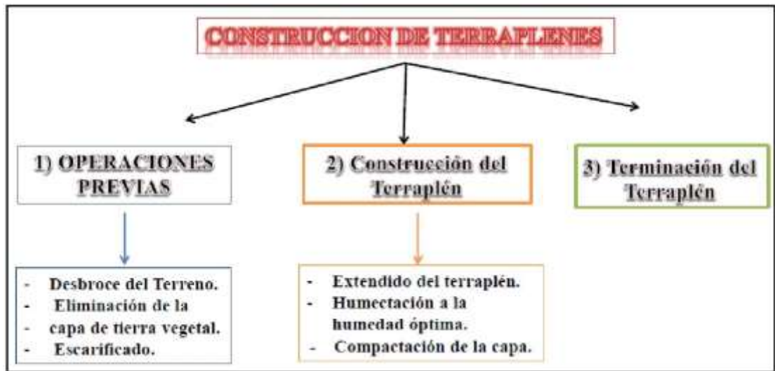
ESQUEMA SOBRE LA CONSTRUCCION DE TERRAPLENES
