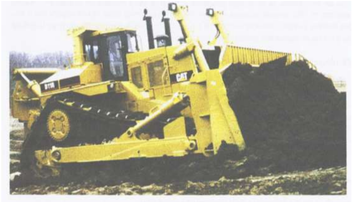
MÁQUINA TRACTORA EFECTUANDO LABORES DE EXCAVACIÓN Y ESCARIFICADO
