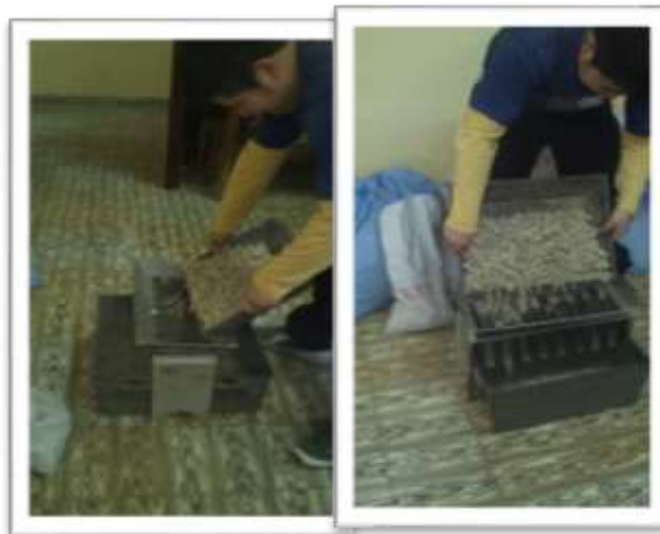
Fig.33 Cuarteo Mecánico de los Agregados Fuente: Elaboración Propia
