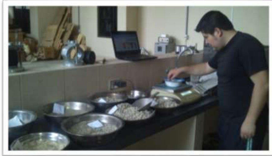
Fig.57 Dosificación de los Agregados Fuente: Elaboración Propia
