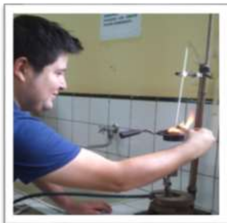
Fig. 23 Punto de Combustión Fuente: Elaboración Propia
