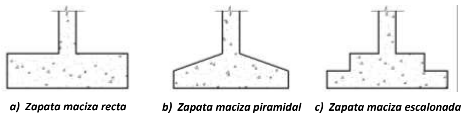
Figura N° 3.15 Tipo de zapatas por su morfología.
